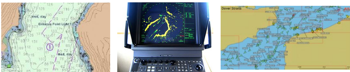
Figura 2.2. Imágenes típicas de ECDIS(izda.), ARPA(centro) y AIS (derecha).
