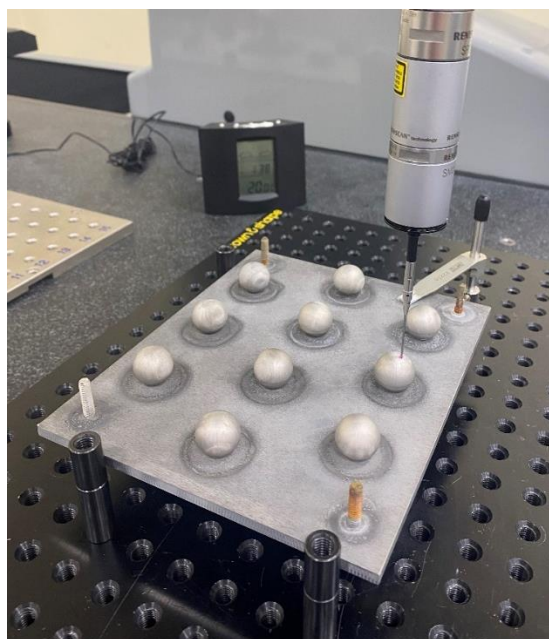
Figura 36. Sujeción con utillaje modular para medición por contacto post-ácido
