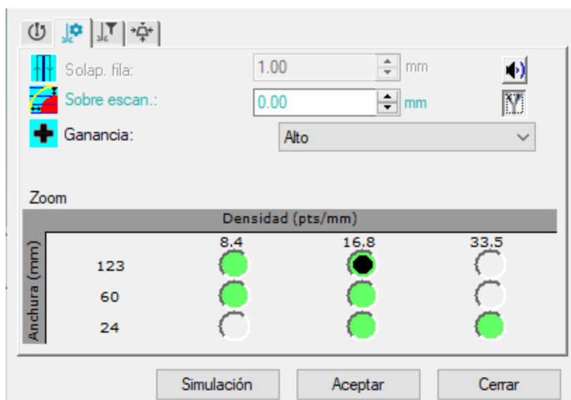
Figura 19. Configuración parámetros del sensor láser HP-L-10.6® pre-ácido
