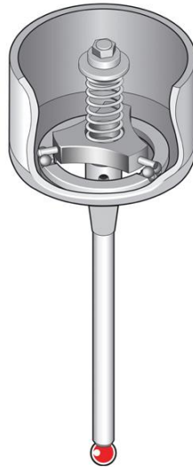
Figura 8. Sonda montada sobre un vástago con resorte
