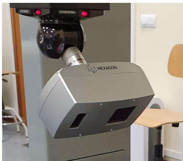
Figura 13. Sensor láser de triangulación HP-L-10.6®
