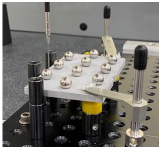
Figura 14. Sujeción con utillaje modular para medición por contacto pre-ácido
