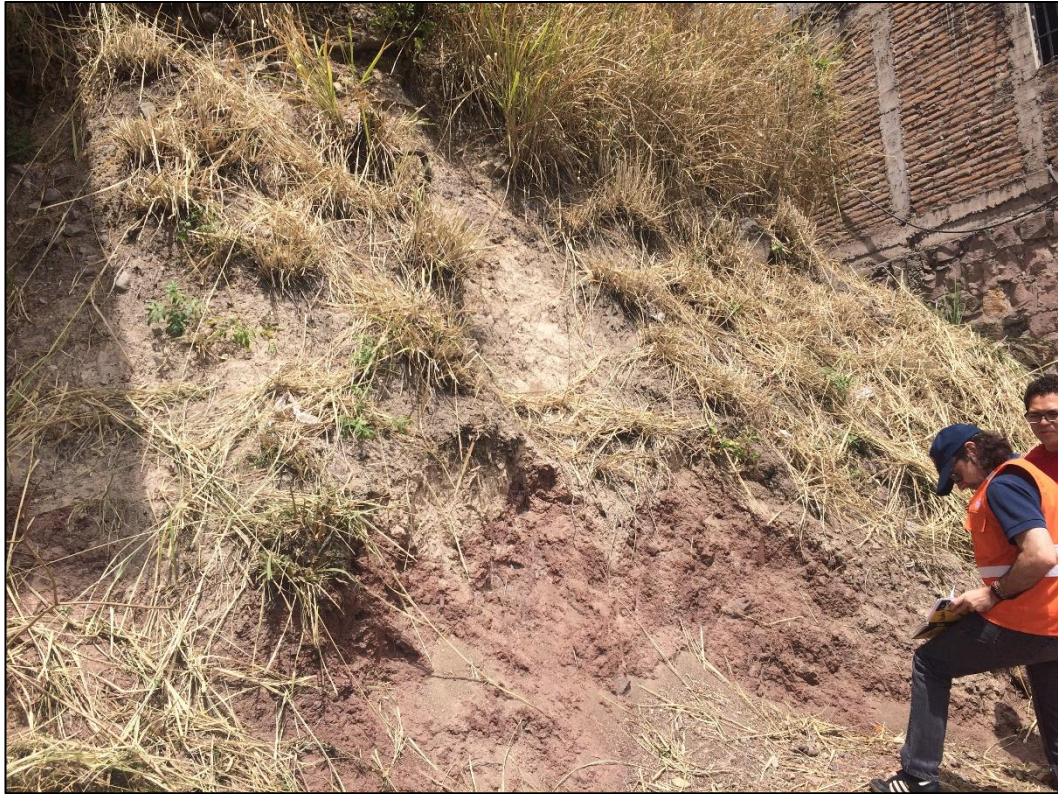
Figura 32. Coluvión de la formación Padre Miguel sobre suelo residual generado por la alteración del Grupo Valle de Ángeles, en las laderas del cerro el Picacho. Foto propia marzo 2018.
