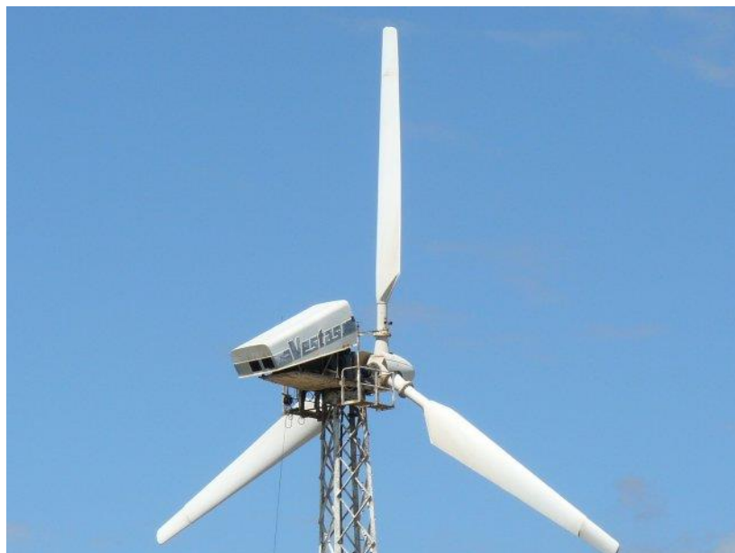
Figura 6.4.- Aerogenerador de eje horizontal de tres palas de la empresa Vestas [51].
