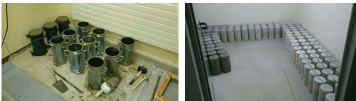
Figura 1. Probetas utilizadas en los ensayos a compresión: fabricación (izquierda) y curado (derecha).
