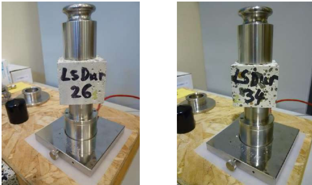
Figura 3. Realización de ensayos de conductividad térmica con MTPS.
