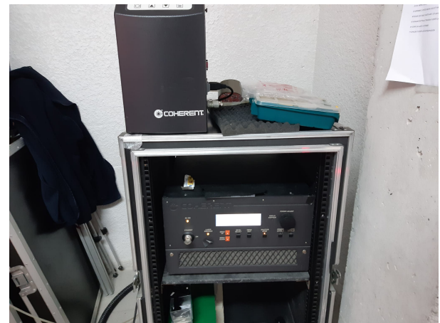
Figura 5.3: Fuente de alimentación y refrigerador.
