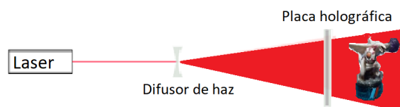
Figura 3.2: Disposición para un holograma de Denisyuk.
