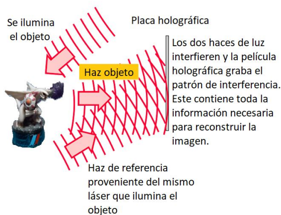
Figura 2.1: Esquema de cómo se graba un holograma.
