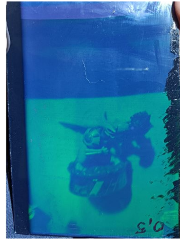
Figura 5.12: Holograma de prueba grabado con 1W de potencia y un tiempo de 0.5s.
