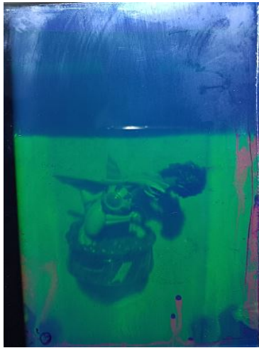
Figura 5.11: Holograma de prueba grabado con 1W de potencia y un tiempo de 0.3s.
