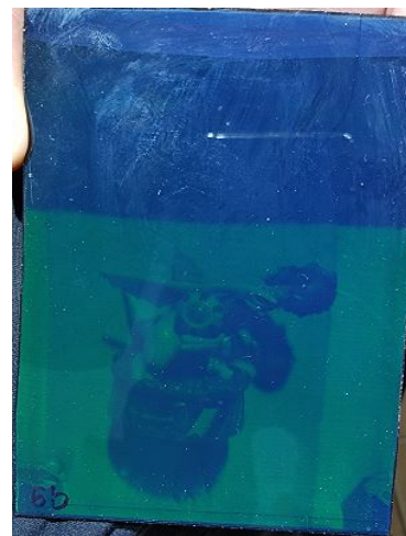
Figura 5.14: Holograma de prueba grabado con 1W de potencia y un tiempo de 0.9s.
