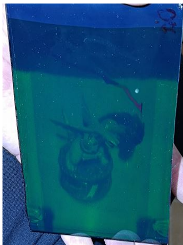
Figura 5.13: Holograma de prueba grabado con 1W de potencia y un tiempo de 0.7s.
