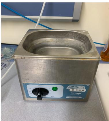
Figura 3.16: Dispositivo de ultrasonidos para el *lift-off*.
