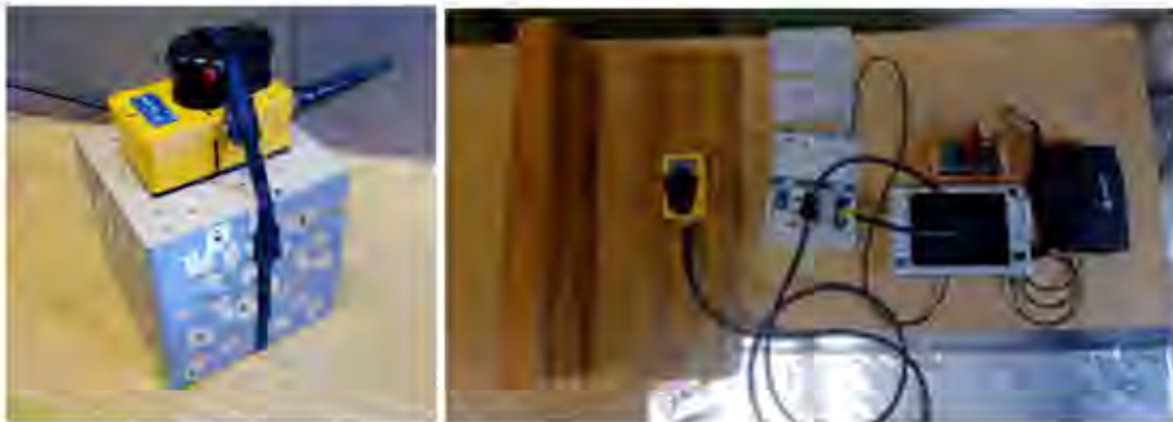
Figuras 5 y 6. Antena sobre probeta de haya y pino silvestre, respectivamente.
