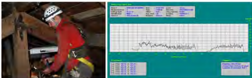
Figuras 3 y 4. Ensayos con resistógrafo.
