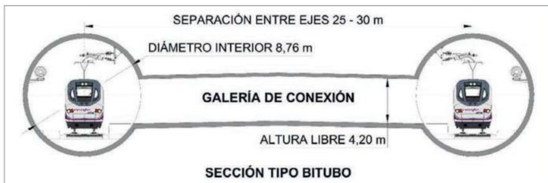
Fig. 42 Sección transversal de ambos túneles
