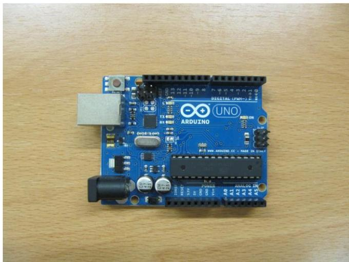
**Figura 84. Tarjeta Arduino UNO, versión R3.**
