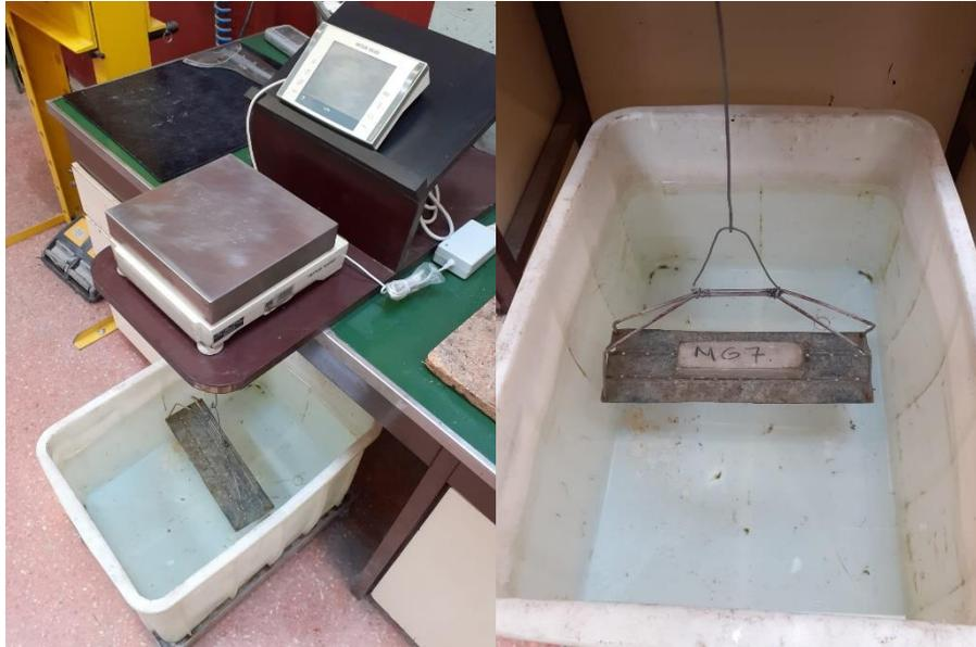
**Figura 39. Balanza de precisión y pesada hidrostática de la probeta de MG 7.**
