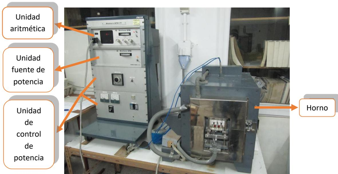
**Figura 85. Componentes del equipo Shotherm QTM-F1.**
