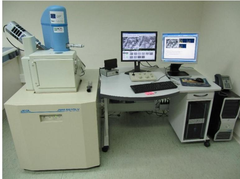
**Figura 55. Microscopio electrónico de barrido con microanalizador EDX.**
