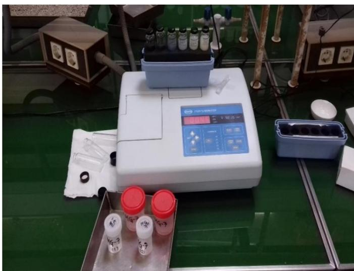
**Figura 58. Calibración del turbidímetro.**
