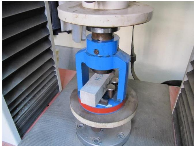
**Figura 50. Ensayo de resistencia a flexión para el estudio de durabilidad del mortero.**
