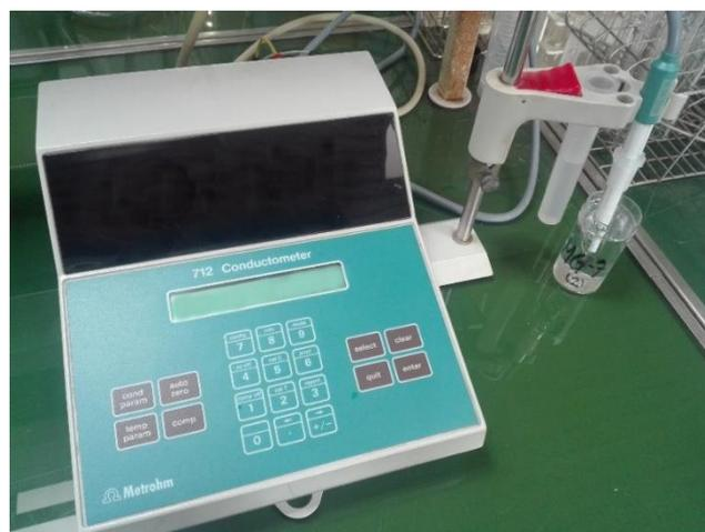
Figura 57. Medición con el conductímetro.
