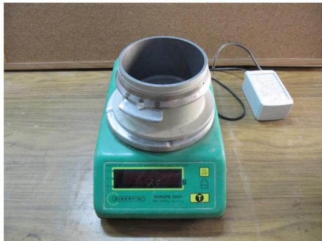
**Figura 38. Balanza de precisión y recipiente para determinar la densidad aparente del MG 7.**
