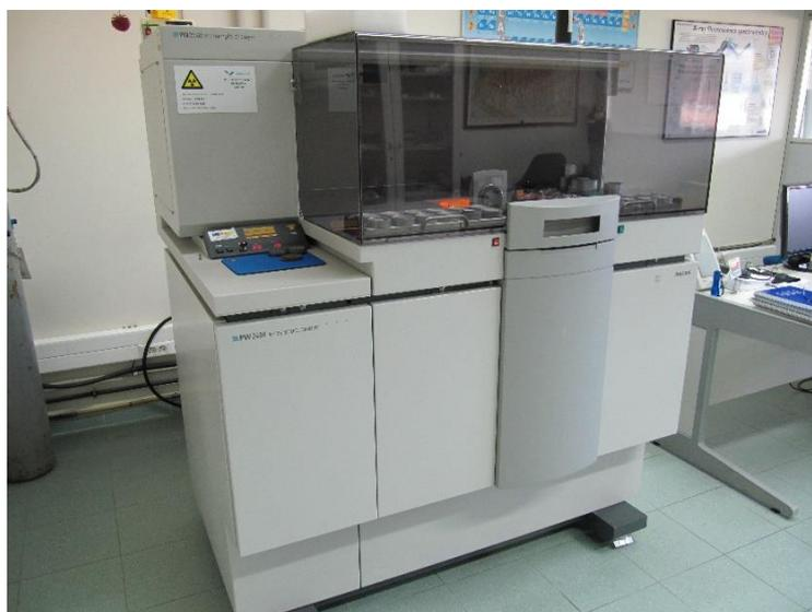
**Figura 51. Espectrómetro de fluorescencia de rayos X por dispersión de longitud de onda.**
