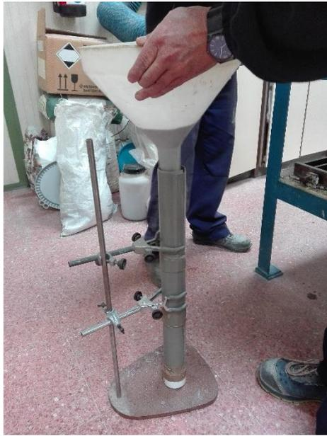
**Figura 41. Llenado del tubo de PVC.**
