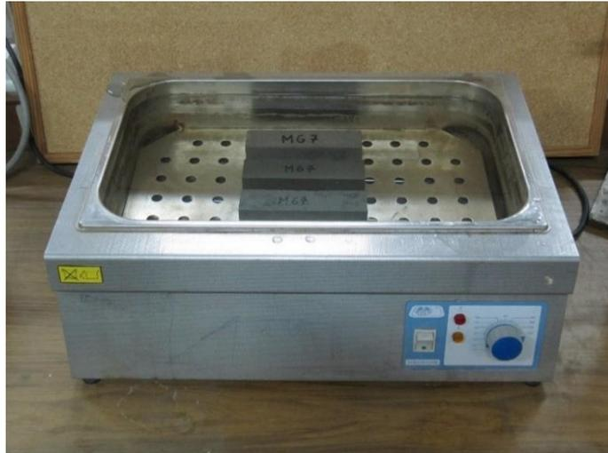
**Figura 49. Probetas sumergidas en el baño termostático durante el ciclo de hielo-deshielo.**
