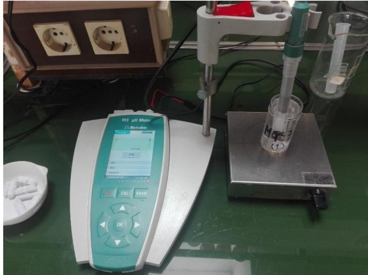
Figura 56. Medición con el pH-metro.
