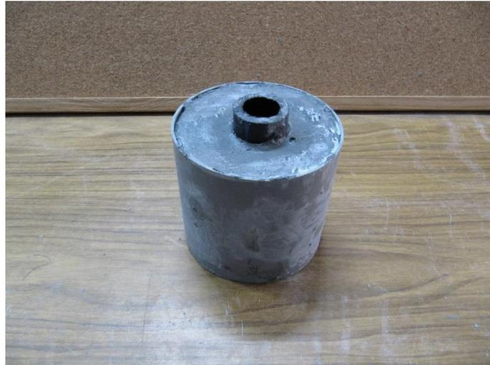
**Figura 47. Conjunto mortero-tubería.**
