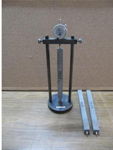
**Figura 43. Ensayo de medida de la retracción lineal con el comparador de longitud.**
