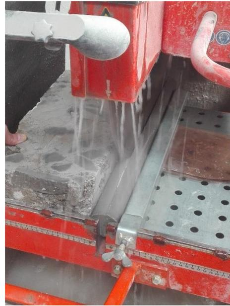
**Figura 42. Corte de la probeta.**
