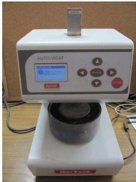
**Figura 36. Aparato de Vicat automático durante el ensayo.**
