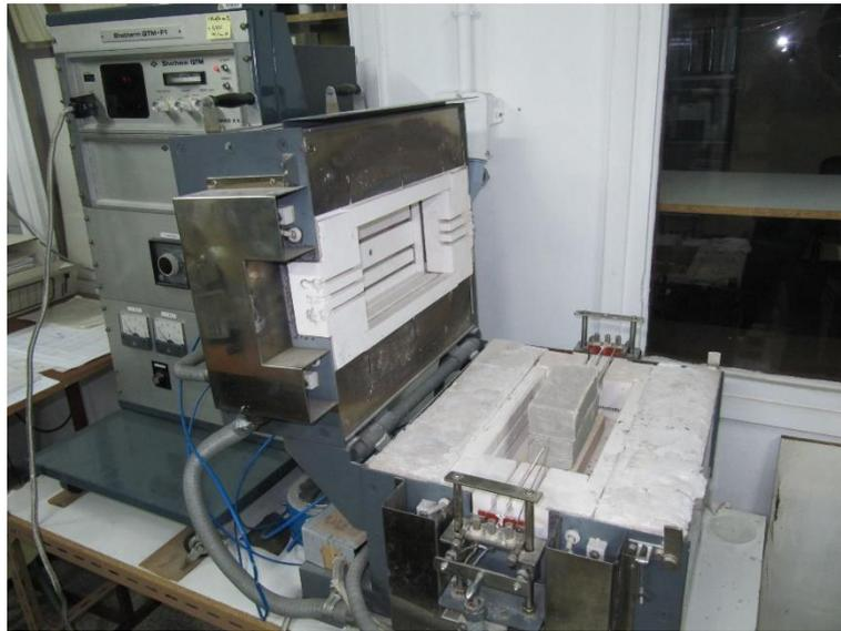
**Figura 24. Ensayo de la conductividad térmica de la muestra M 03 con el equipo comercial.**
