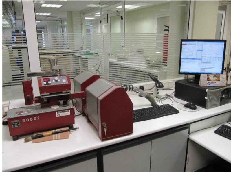
**Figura 28. Equipo de difracción láser para el ensayo granulométrico de CVP, CVA, EB y MS.**
