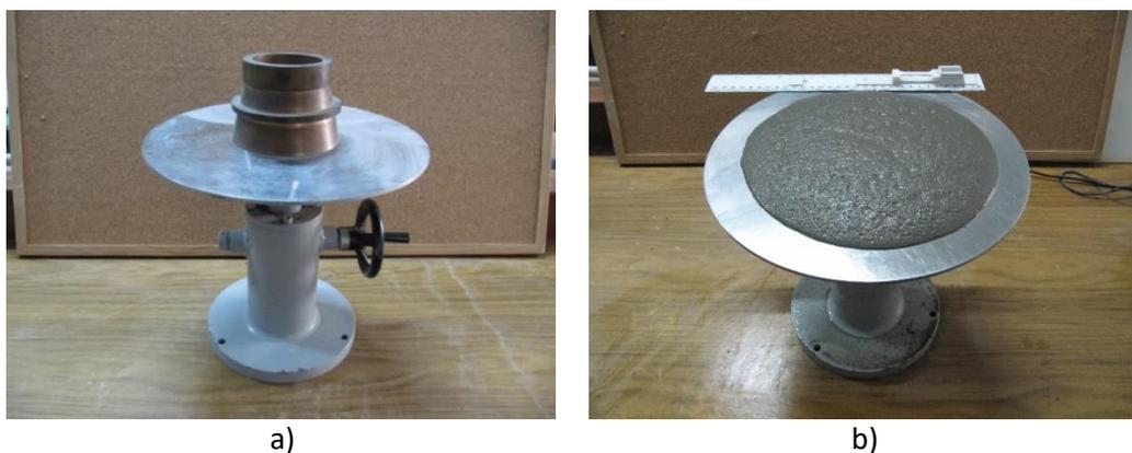
**Figura 35. a) Mesa de sacudidas y molde troncocónico. b) Realización del ensayo.**
