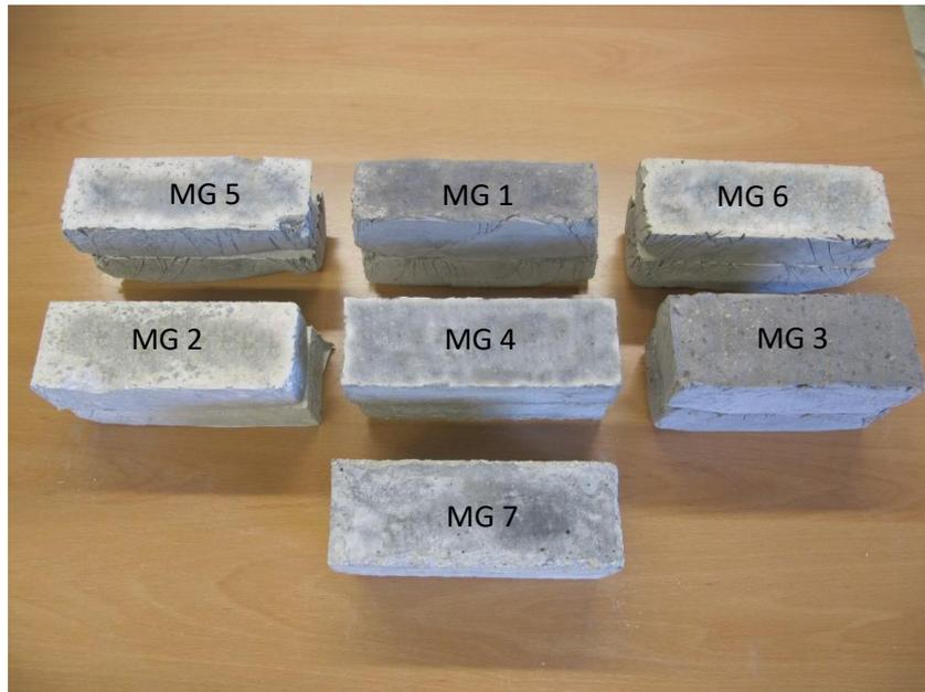
**Figura 31. Morteros geotérmicos candidatos.**
