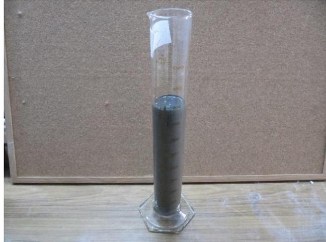
**Figura 37. Ensayo de exudación del mortero MG 7 fresco.**
