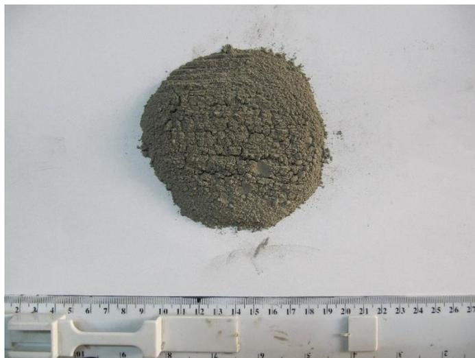
**Figura 26. Mortero geotérmico seco MG 7.**
