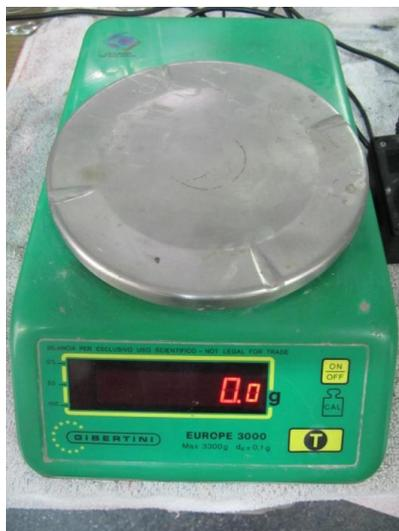
Figura 17. Balanza de precisión.
