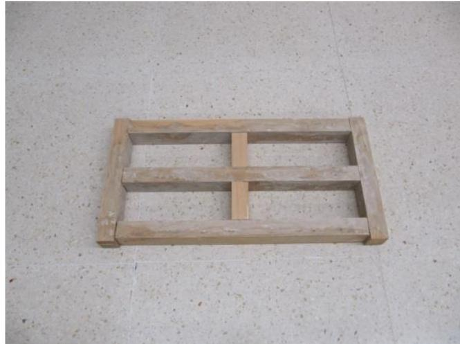
**Figura 19. Molde para cuatro probetas.**
