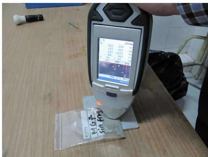
**Figura 52. Analizador portátil de fluorescencia de rayos X por energía dispersiva.**
