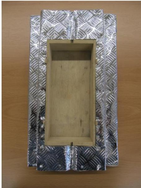
**Figura 10. Vista de la pieza inferior del molde.**
