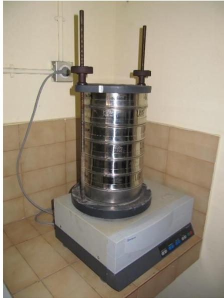
**Figura 34. Tamizadora electromagnética con la columna de tamices.**
