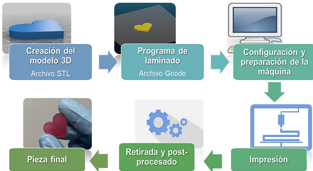
Figura 1.3-1. Etapas generales del proceso de impresión 3D.
