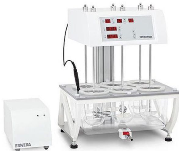
Figura 4.6-11. Aparato tipo USP-II estandarizado empleado para el estudio de liberación.
