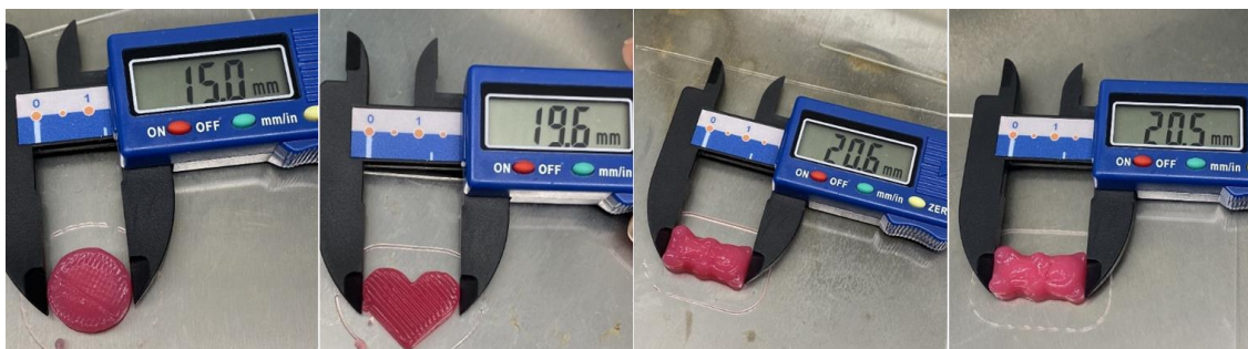
Figura 4.6-7. Detalle del procedimiento de medida con calibre de la longitud de las figuras impresas con F1.
