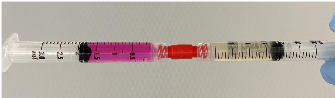
Figura 2.3-11. Detalle de las jeringuillas con parte A (izda.) y parte B (dcha.) unidas con el conector de transferencia tipo hembra-hembra.
