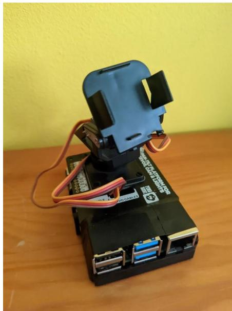
Figura 1.9.- Fotografía de la Raspberry Pi 4 y el servomotor utilizados.
