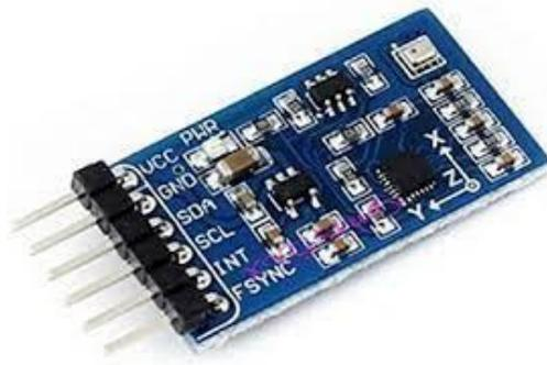
Figura 1.17.- Imagen de un sensor IMU
