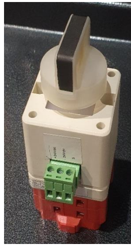
Figura 40. Conmutador de mando y señalización tricolor MT de la marca Gave. Fuente: fotografía propia.
