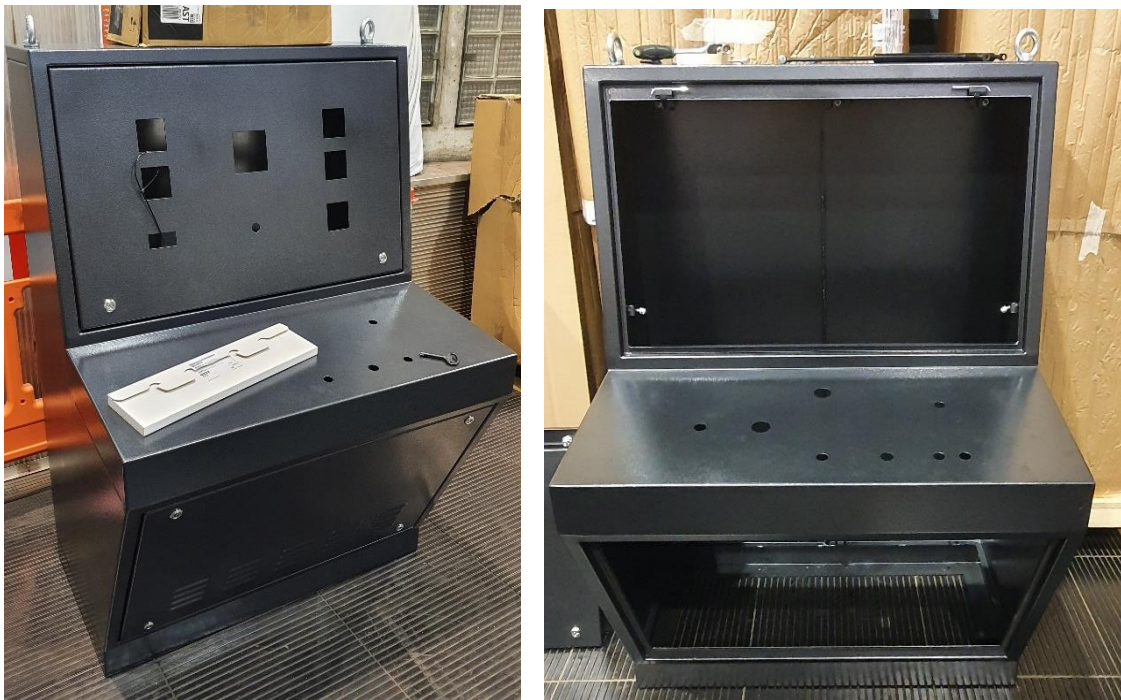
Figura 22. Pupitre metálico que dará soporte a todo el cuadro eléctrico. Fuente: fotografías propias.
