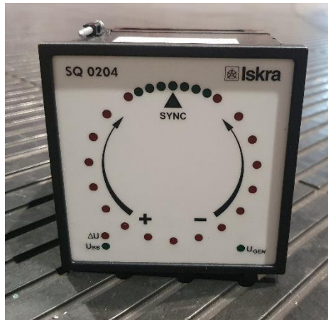
Figura 36. Sincronoscopio. Fuente: Fotografía propia.
