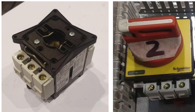
Figura 27. Seccionador con y sin ruleta. Fuente: fotografías propias.
