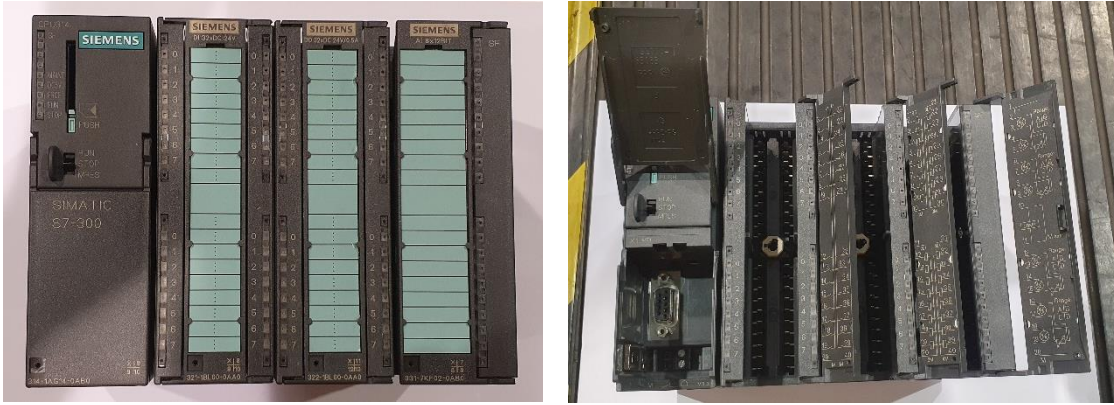
Figura 26. Autómata lógico programable (PLC) cerrado (izqda.) y abierto (dcha.). Fuente: fotografías propias.
