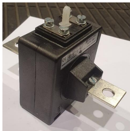
Figura 32. Transformador de corriente. Fuente: fotografía propia.
