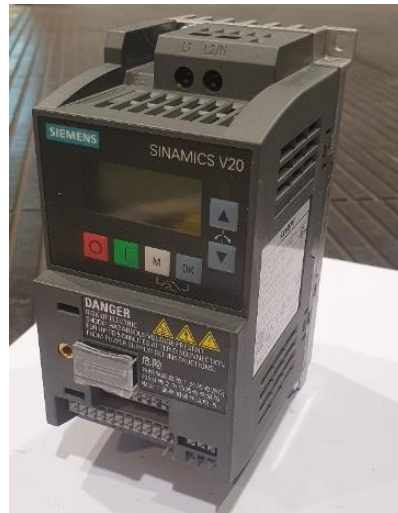
Figura 31. Variador de frecuencia. Fuente: fotografías propias.
