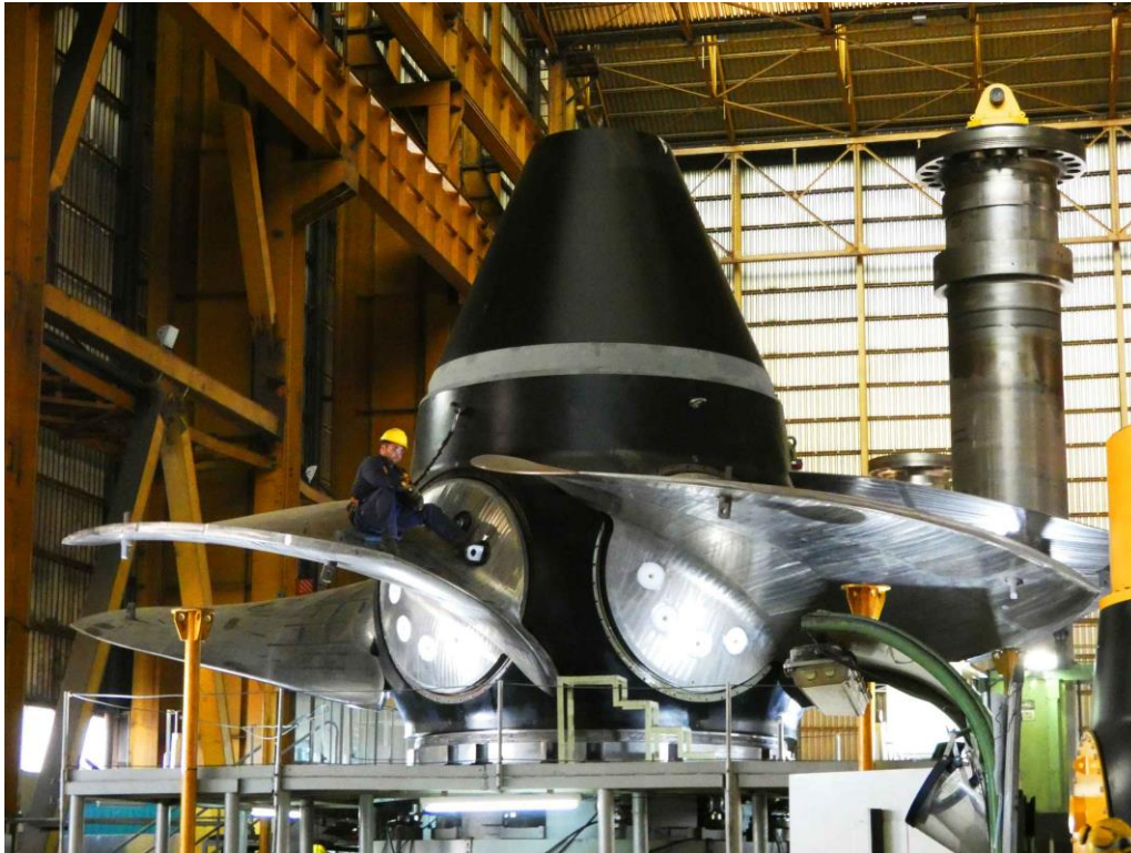
Figura 13. Montaje de una turbina Kaplan. Fuente: Fabricante IMPSA.
