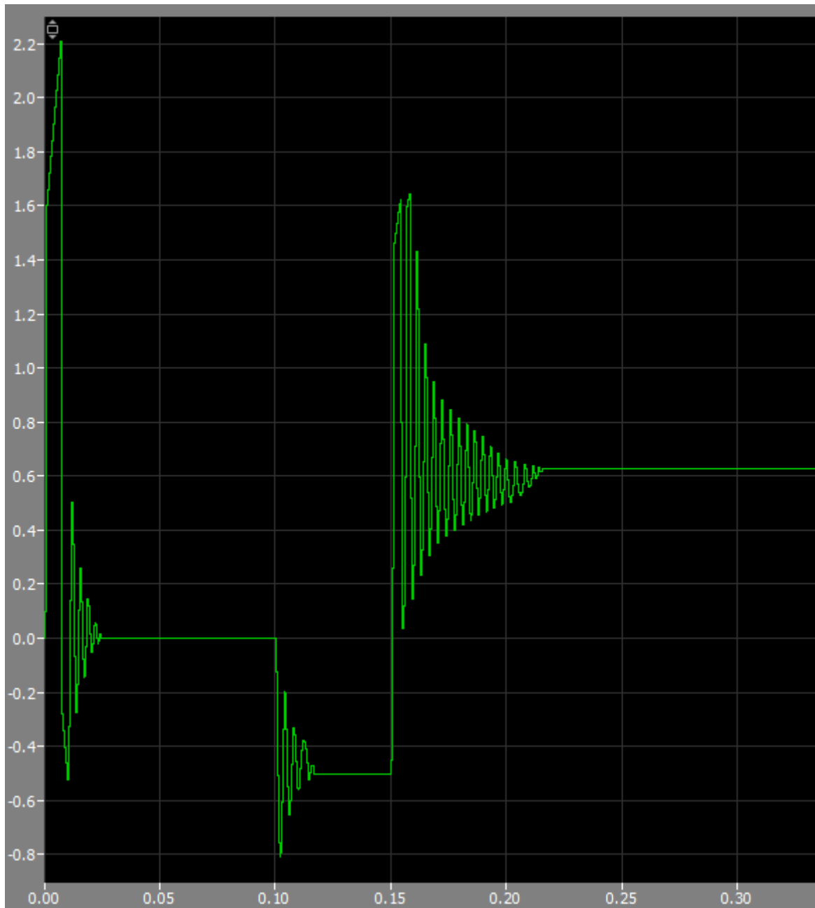
Figura 6.5.10: Desfase en el secundario, con cargas adicionales.
