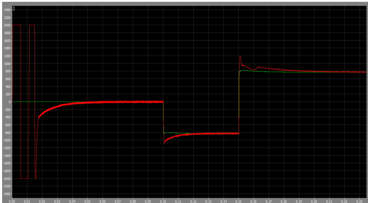
Figura 6.7.2: Comparación de la potencia de referencia con la potencia controlada, con regulador.
