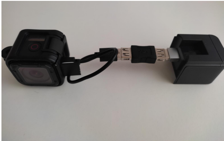
Figura 36: Segunda cámara y conexión a batería externa.
