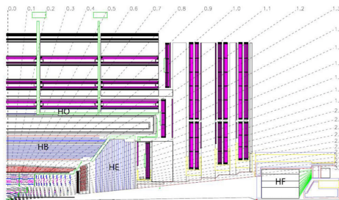
Figura 2.11: Corte longitudinal del calorímetro hadrónico que muestra la localización de los calorímetros HB, HE, HO y HF. [34]
