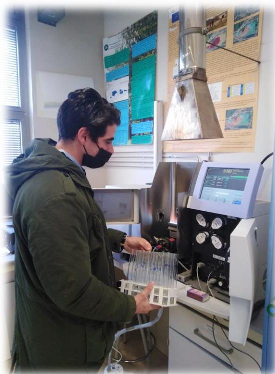
Figura 8.8 Determinación de la curva de absorbancia en el aparato de absorción atómica para cálculo de la capacidad de intercambio catiónica efectiva. Enero 2022
