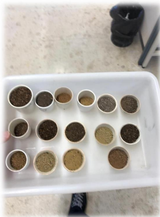
Figura 8.4 Muestras a introducir en horno para determinar materia orgánica (%). Octubre, 2021.
