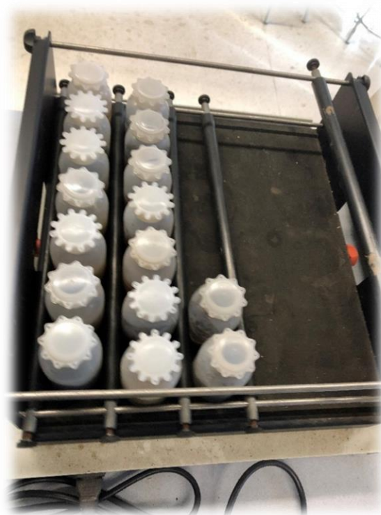
Figura 8.3 Preparación de las muestras para cálculo del pH y conductividad eléctrica. Octubre, 2021.
