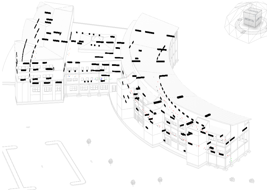
Ilustración 7.38. Radiadores Aulario Norte Europa C
