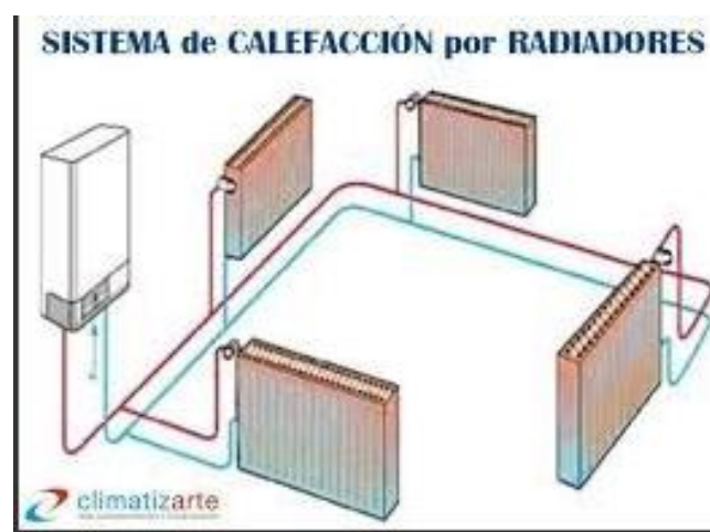
Ilustración 5.5. Instalación de calefacción 30
