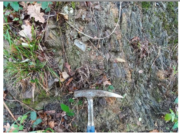
Alternancia de areniscas silíceas de 10-20 cm de potencia en GM-III y limolitas parcialmente alteradas a arcilla.
