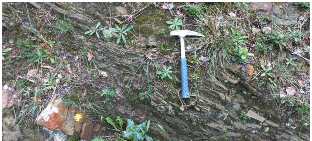
Detalle del afloramiento de alternancia de areniscas silíceas en estratos centi-decimétricos en cuerpos lenticulares junto con alternancia de areniscas y limolitas calcáreas en estratos milimétricos a centimétricos. PK 0+420.
