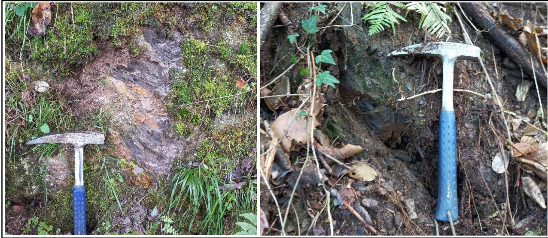
Figura 4.3. Detalle de tramos limolíticos ligeramente alterados (izquierda) e intensamente alterados (derecha).
