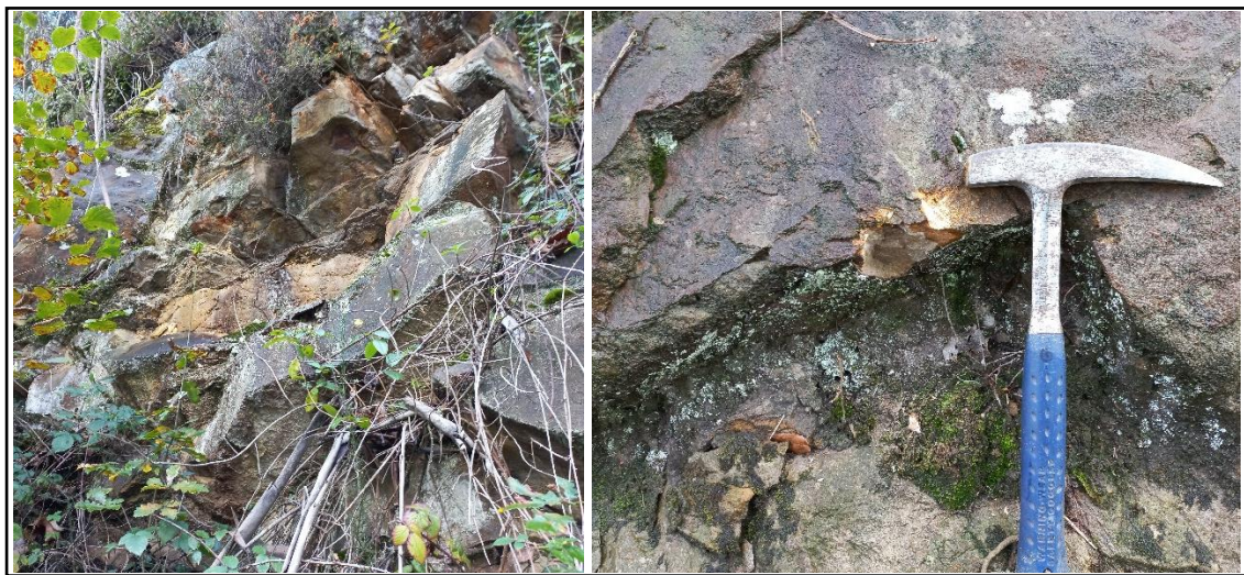
Figura 4.4. Detalle de estratos de arenisca sanas a ligeramente alteradas que forman cuerpos lenticulares.
