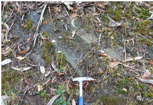
Afloramiento del PL 13 en el PK 0+660. Areniscas silíceas dispuestas en estratos entre 5 a 10 cm en GM-III,
