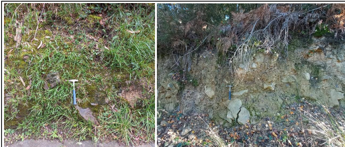
Figura 4.7. Afloramientos de la masa de coluvial en taludes de la carretera (izquierdo) y de la pista forestal (derecho).
