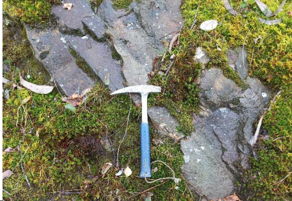
Estrato de arenisca de 50 cm de potencia que adquiere morfología lenticular, en PK 0+680.
