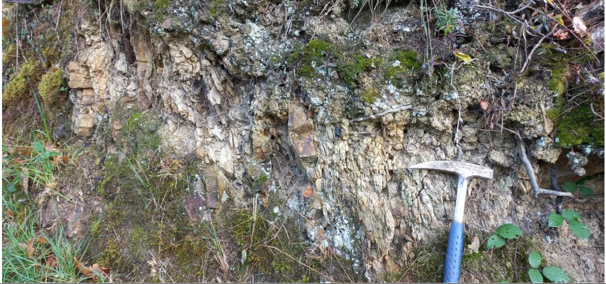
Detalle del afloramiento del PL 12 con areniscas silíceas en estratificación centimétrica, en cuerpos lenticulares, con intercalaciones milimétricas de limolitas, alterado a GM-IV.
