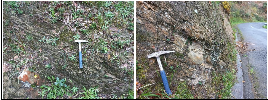
Figura 4.1. Detalle de afloramientos con alternancia de areniscas tableadas y limolitas en alternancia centimétrica.
