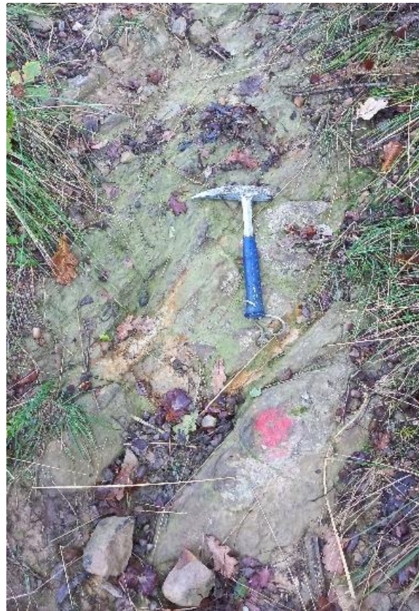
Afloramiento del PL 20 en el suelo de la pista forestal, formado por areniscas silíceas micáceas en estrados decimétricos.
