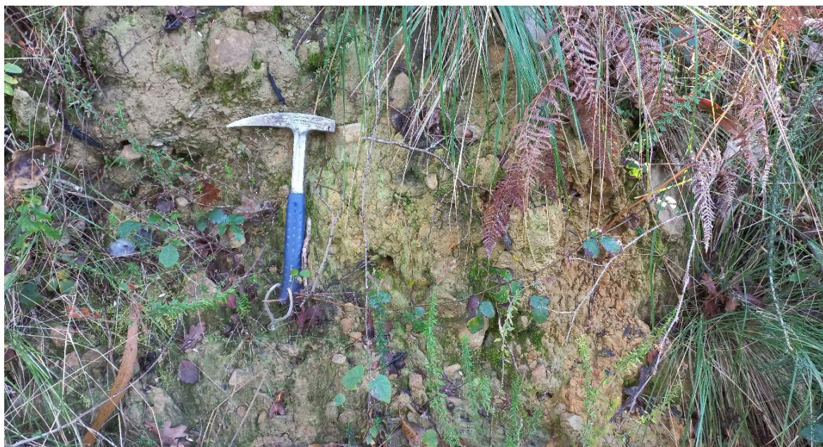
Detalle del afloramiento donde se establece el PL20. Se observa un eluvial formado por arcillas arenosas duras con algún clasto de arenisca intensamente alterada.
