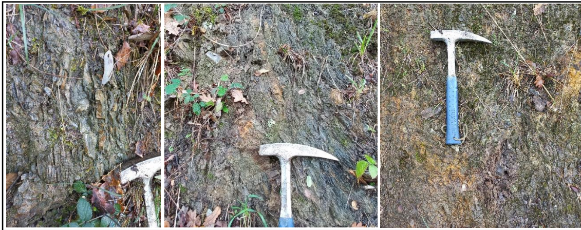
Figura 4.2. Detalle de intercalación milimétrica de areniscas y limolitas laminadas y onduladas.
