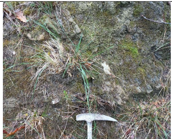
Areniscas silíceas alternantes con limolitas en potencia milimétricas en GM-III-IV.
