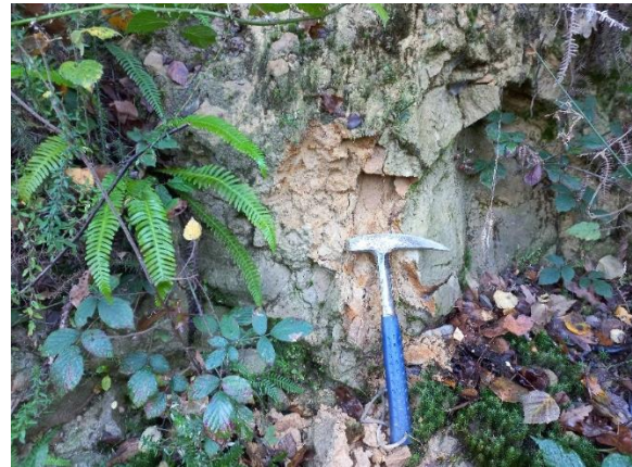
Detalle del afloramiento donde predominan las areniscas silíceas de color gris claro, alteradas a GM-IV.
