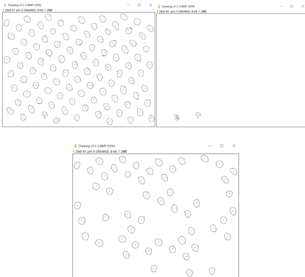
Figura 21: (a) ninguna especificación en la circularidad (b) circularidad entre 0 y 0.5 (c) circularidad mayor de 0.6.
