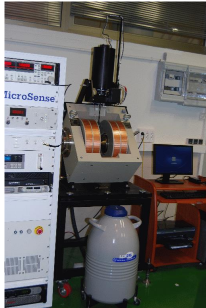
Figura 22: VSM de los Servicios Científico Técnico de la Universidad de Oviedo, con el cual se tomaron las medidas de la imanación frente a la temperatura [21]
