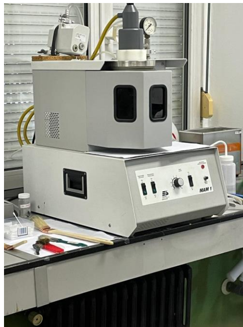
Figura 12: imagen del exterior de un horno de arco cuando la cámara se encuentra cerrada y se puede fabricar la aleación.
