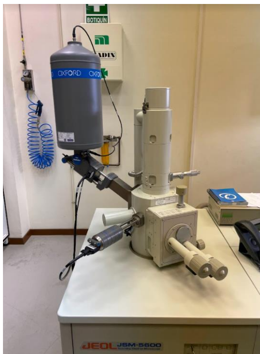
Figura 16: imagen del microscopio electrónico de barrido usado para tomar las medidas.
