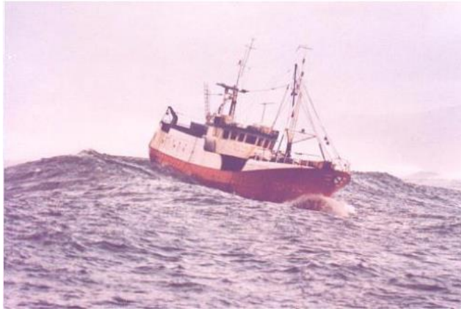
Imagen 22- Reacción de un buque ante la caída por través. Fuente: CIAIM
