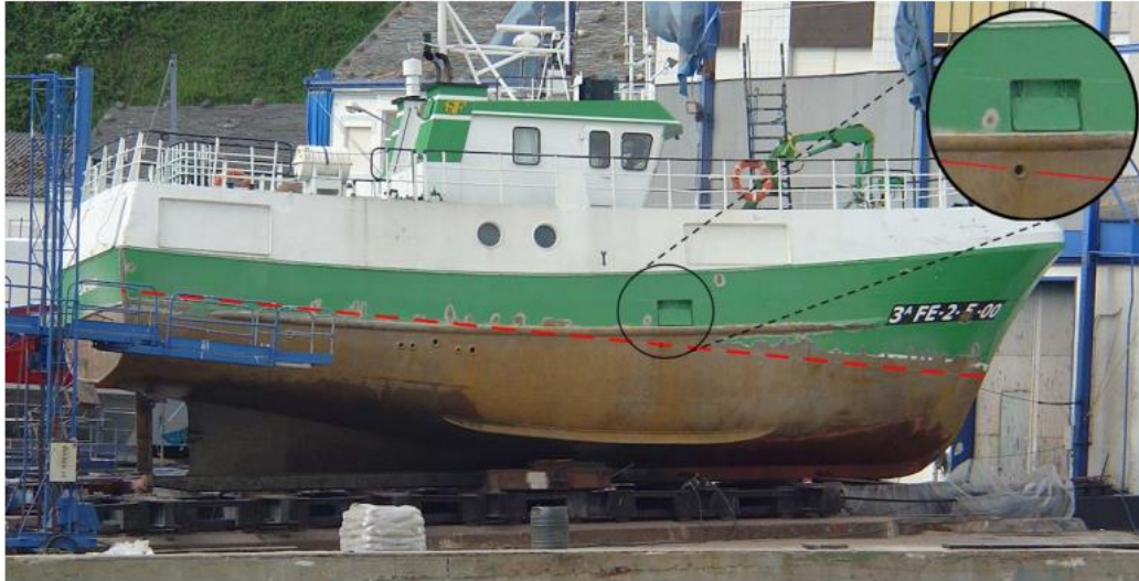
Imagen 35- Abertura por donde se supuso que entro el agua. Fuente: CIAIM
