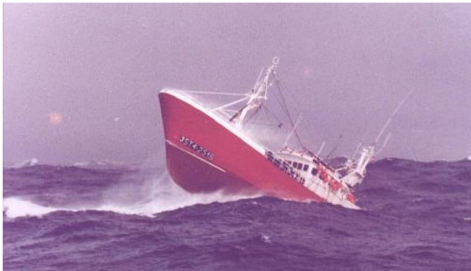
Imagen 23- Reacción del buque ante el embate sucesivo de olas por popa. Fuente: CIAIM
