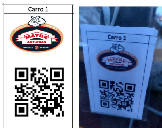
Ilustración 36: Diseño y fotografía de las tarjetas con Código QR dispuestas en los carros / bastidores de chorizos en la sala de ahumado.
