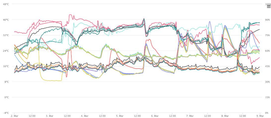
Ilustración 47: sensores de temperatura instalados y el comportamiento de lectura estable sin huecos después de los ajustes realizados en las comunicaciones.
