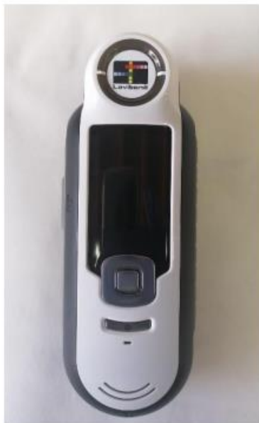
Figura 15.- Colorímetro utilizado para medir las propiedades colorimétricas de las muestras de aceite y de los films .
