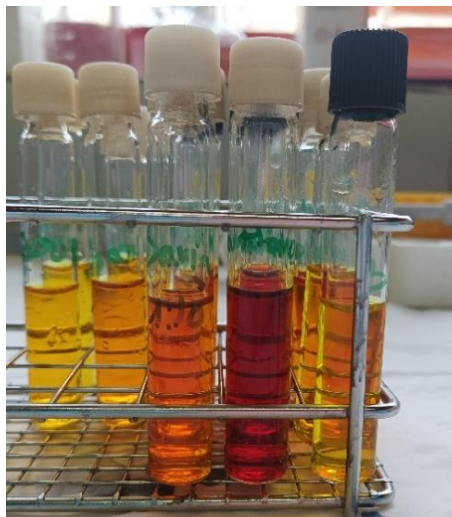
Figura 18.- Resultado de la cuantificación de los azúcares reductores, observando distintas tonalidades (naranja oscuro con la dilución 1:10 de la savia, rojizo con la savia sin diluir y amarillo en el blanco).
