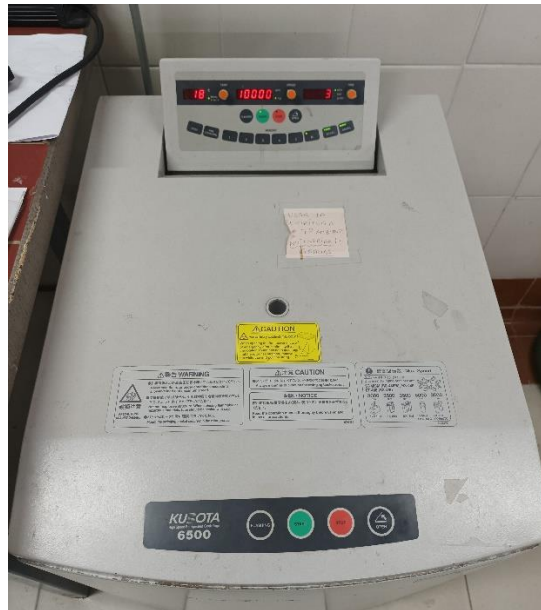
Figura 12.- Centrifugadora 6500 (Kubota) empleada antes de realizar la liofilización de la savia.
