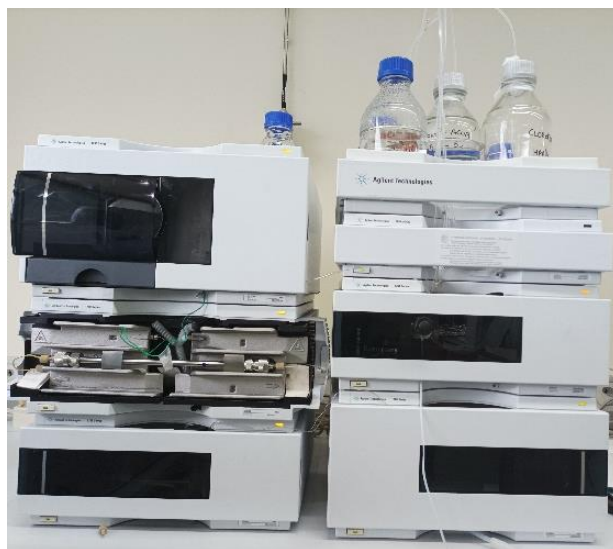
Figura 4.- Equipo HPLC Agilent 1200 utilizado en la determinación de ácidos orgánicos.
