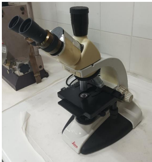
Figura 7.- Microscopio DME (Leica) empleado para observar los resultados microbiológicos de la savia de abedul.
