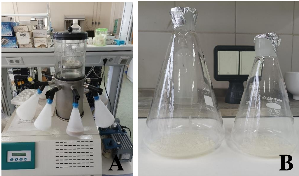
Figura 5.- (A): Liofilizador LFD-10C Freeze Dryer empleado para la extracción de muestra liofilizada. (B): Muestra liofilizada repartida en dos matraces de 200 mL.
