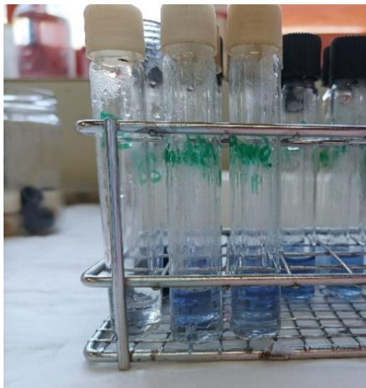
Figura 20.- Resultado de la cuantificación de los fenoles, observando distintas tonalidades (azul claro con la savia y transparente en el blanco).
