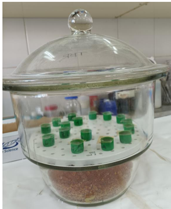
Figura 17.- Taponés sellados con trozos de film de caseína y gelatina junto con savia, en el desecador para el estudio de la permeabilidad de vapor de agua de estos films .
