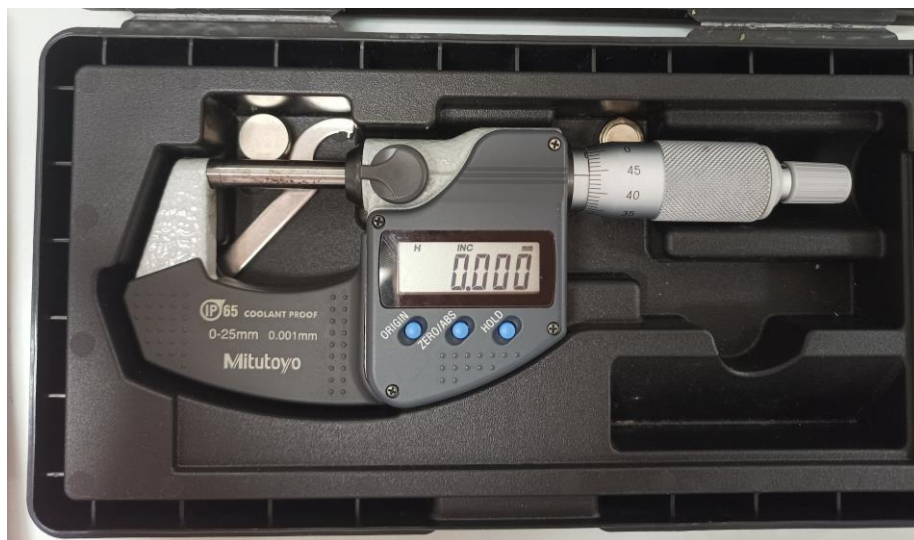
Figura 14.- Micrómetro digital (Mitutoyo C., Japón) empleado para medir el grosor de los films .
