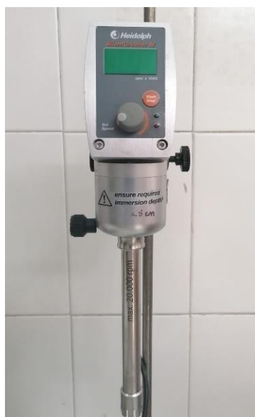
Figura 11.- Homogeneizador Silent Crusher (Heidolph, Alemania) con el rotor 12 GM empleado en la elaboración de films de caseína y savia de abedul.
