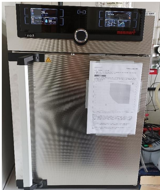
Figura 13.- Cámara de humedad HCP50 (Mettmert) empleada para el mantenimiento de los films .
