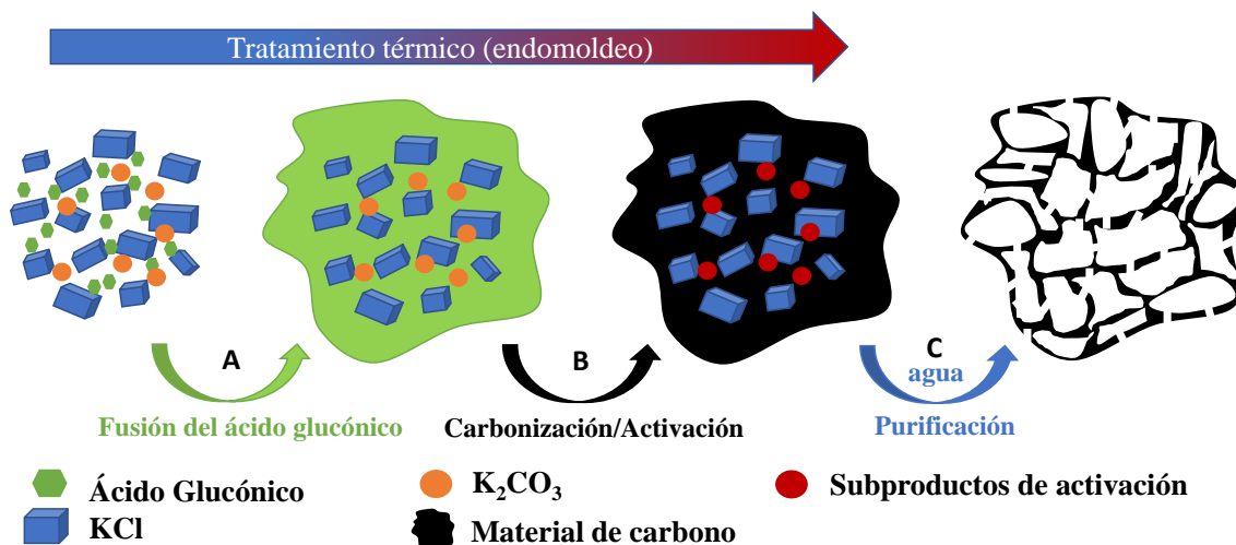
Figura 6.1. Esquema del procedimiento experimental para la síntesis de los materiales de carbono para cátodos de SICs. (Fuente: elaboración propia)
