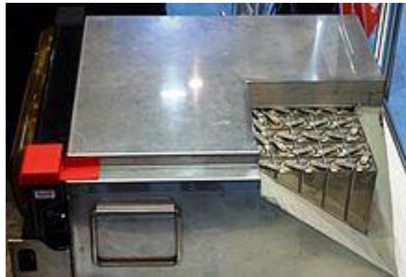
Figura 4.38: Detalle de una batería de sales fundidas [70]
