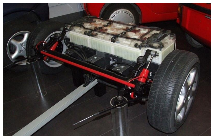
Figura 4.35: Batería de Ni-Cd empleada en un automóvil [67]
