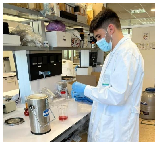
Figura 8: Formación de las gotas de PBCF usando \text{N}_2 (l)
