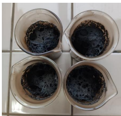
Figura 12: PBCF tras el tratamiento térmico a 300\text{ }^{\circ}\text{C}
