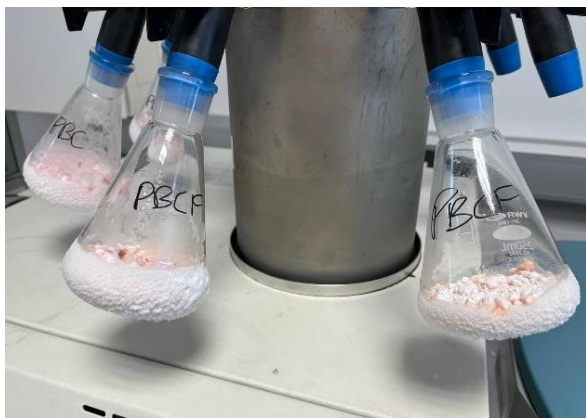
Figura 9: Matraz Erlenmeyer con las gotas congeladas de PBCF ensamblado en el liofilizador
