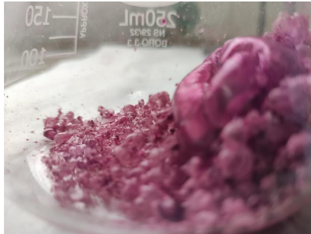
Figura 18: Muestra de PBC descartada tras una mala liofilización.
