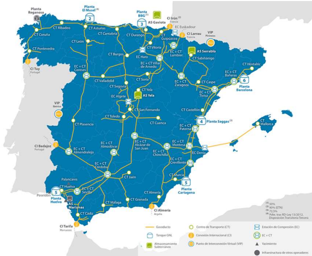
Gráfico 2 - Esquema sobre el sistema gasista español mostrado en la página web de Enagás. Téngase en cuenta que actualmente, el suministro del gasoducto de Tarifa permanece interrumpido debido a la crisis entre Argelia y Marruecos Fuente: Enagas.
