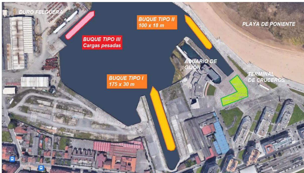
Imagen 35 - Esquema que muestra una hipotética zona de atraque de buques tras la adecuación del entorno de los antiguos astilleros de Naval Gijón. Fuente: Elaboración propia del autor a partir de una captura de pantalla del programa Google Earth.
