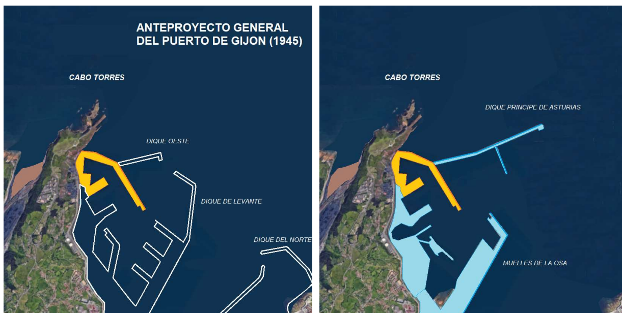
Imagen 10 - Esquemas mostrando la previsión de construcción recogida en el Anteproyecto General de 1945 y a su lado la configuración real que mostraba el puerto a finales de los 70. Fuente: Elaboración propia del autor a partir de una captura de pantalla del programa Google Earth.
