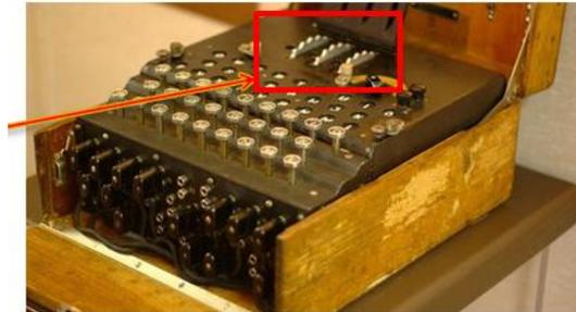
**Figura 10. Los rotores en una Máquina Enigma**
