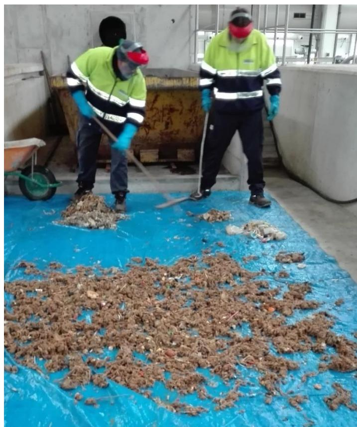
Figura 6: Clasificación de los sólidos de desbaste
