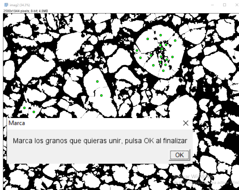
FIGURA 7. Unión manual de los granos segmentados automáticamente por rutina (ImageJ).
