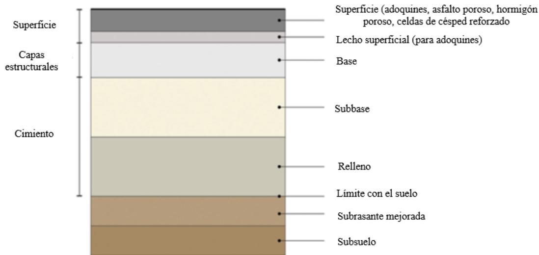
Figura 21. Capas existentes en un pavimento permeable. (19)
