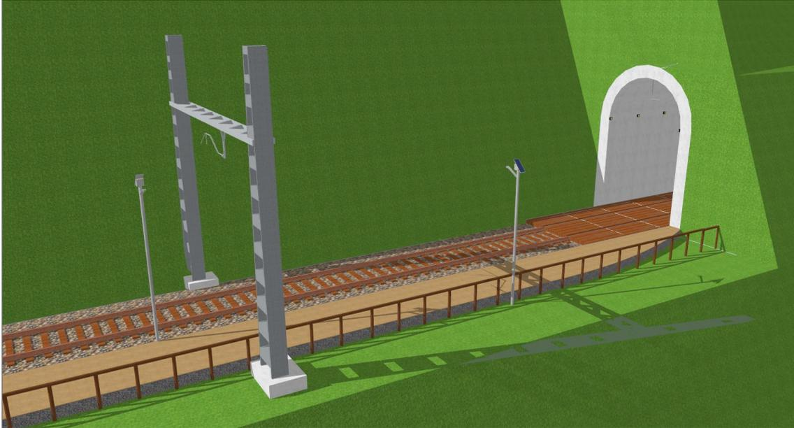
*Figura 18. Modelo de adaptación de túneles, que también puede aplicarse a viaductos y zonas estrechas, con entarimado de madera. (Elaboración propia)*
