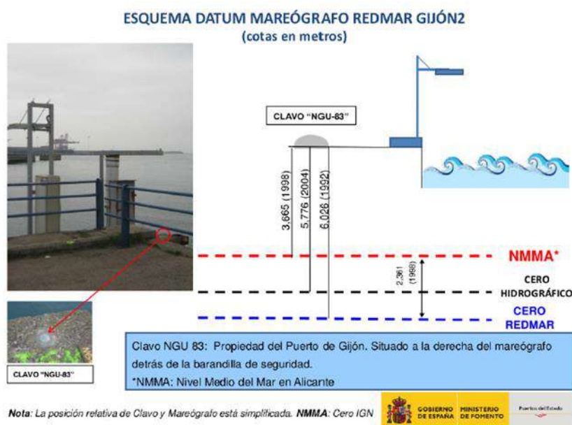
Figura 3. Esquema Datum Mareógrafo REDMAR-Gijón. (Fuente: REDMAR. Red de Mareógrafos de Puertos del Estado. Puerto de Gijón)
