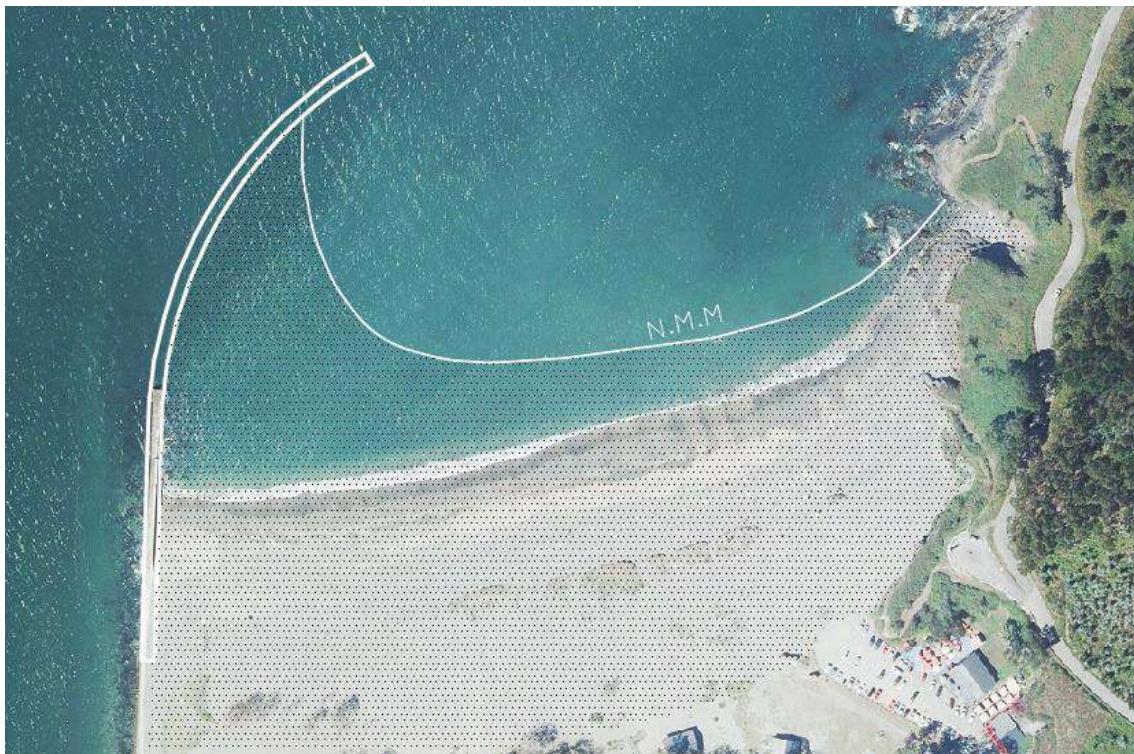
Figura 5. Línea de orilla. Nivel Medio del Mar (N.M.M) previsto para la playa con el espigón curvo. (Fuente: Elaboración propia)
