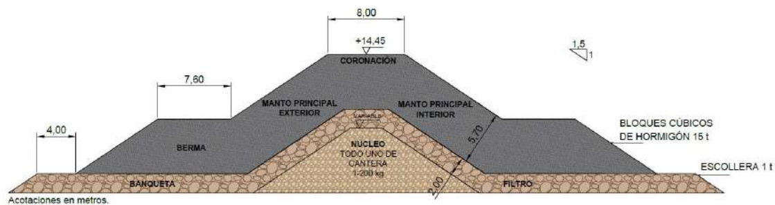
Figura 8. Sección tipo morro de la solución adoptada. (Fuente: Elaboración propia)
