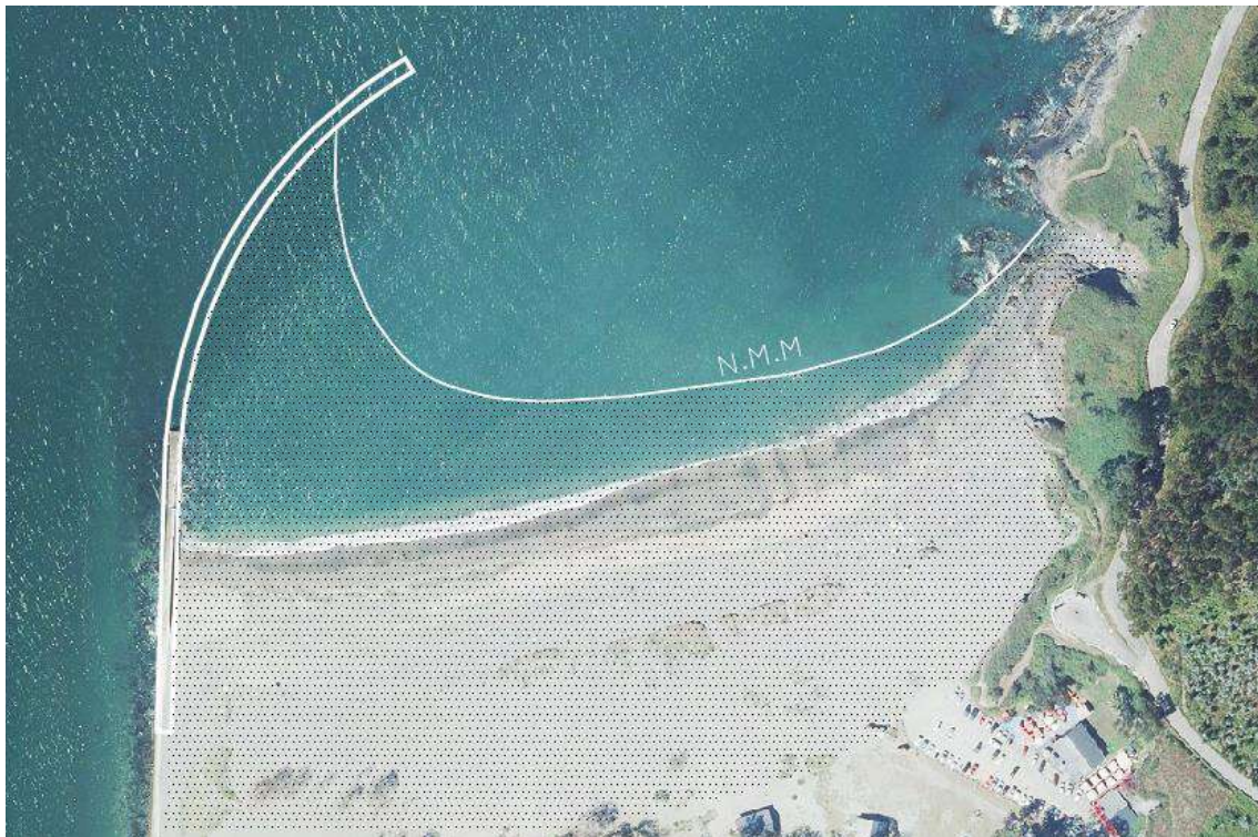
Figura 6. Línea de orilla. Nivel Medio del Mar (N.M.M) previsto para la playa con el espigón curvo.
