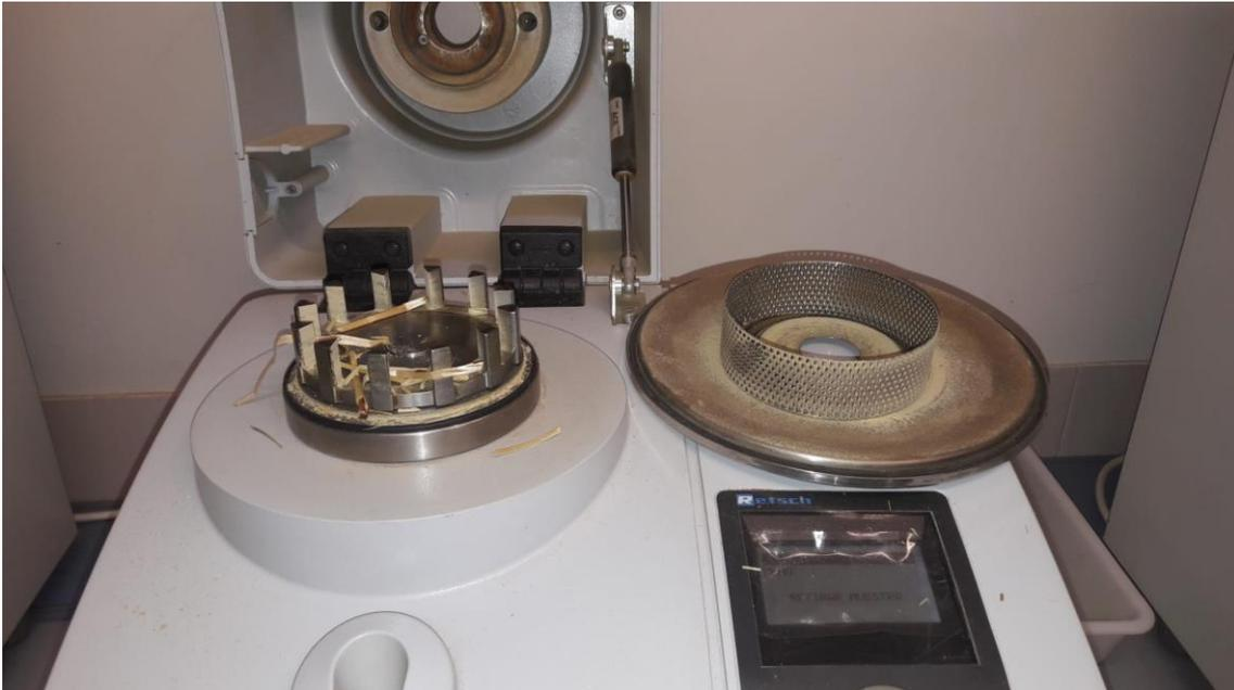
*Figura 3. Máquina empleada para triturar las muestras de hojas y tallos*
