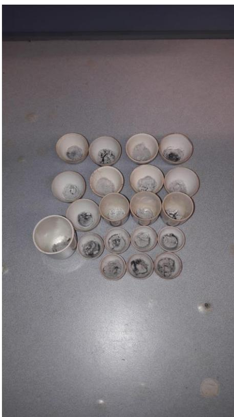
*Figura 6. Calcinación de la muestra en los crisoles*
