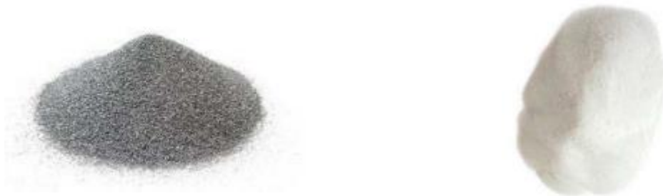
Figura 8. Diferentes proyectiles usados en shot peening (a) acero y (b) vidrio
