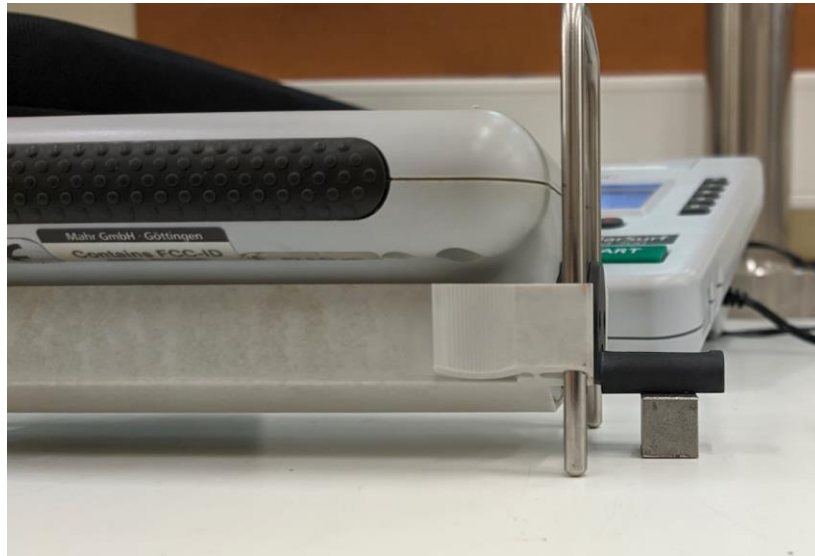
Figura 25. Detalle de la metodología de la medición de la rugosidad
