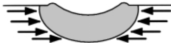
Figura 6. Representación de tensiones residuales de compresión. [18 ª ]
