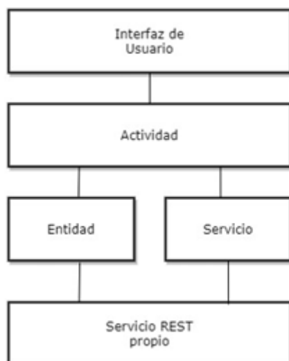
Figura 33. Esquema de la arquitectura de la aplicación móvil
