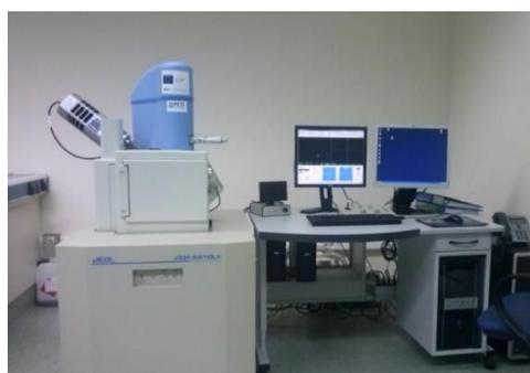
**Figura 4.1.-** Modo de funcionamiento y microscopio electrónico de barrido (JEOL 6610 LV, Servicios Comunes de Investigación de la Universidad de Oviedo) utilizado en el presente estudio.
