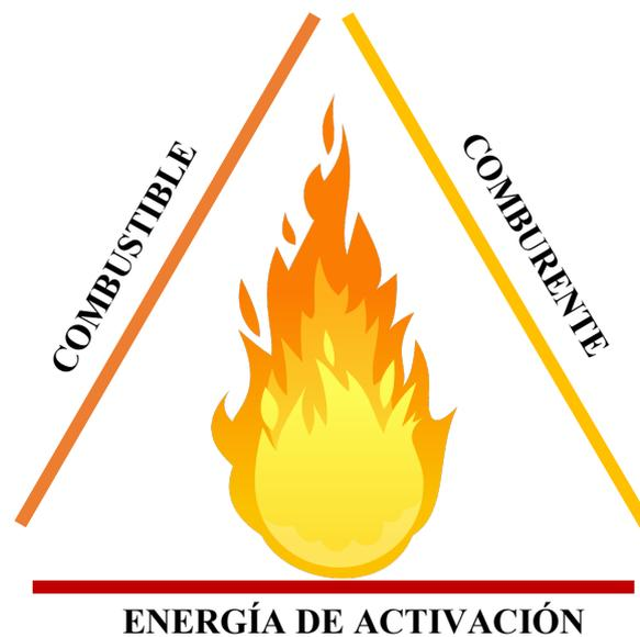
*Figura 2: Triángulo del fuego*
