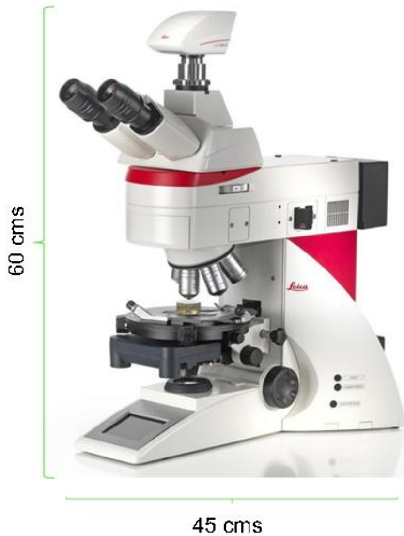
Figura 5.5. Microscopio óptico LEICA DM4P LED, el cual cuenta con luz blanca reflejada, luz transmitida y modo fluorescencia, utilizado en este trabajo.
