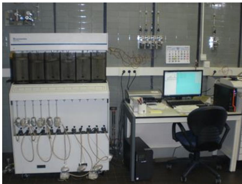
Figura 5.22. Equipo de adsorción de N_2 Micromeritics ASAP 2420, utilizado en este estudio, propiedad del INCAR-CSIC.
