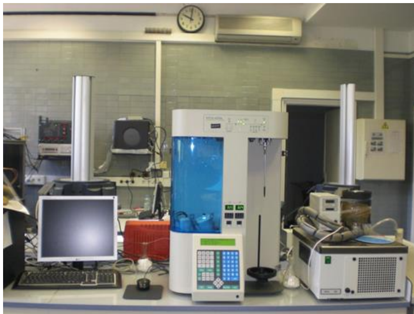
Figura 5.23. Equipo de adsorción de CO_2 Quantachrome NOVA 4000, utilizado en este estudio, propiedad del INCAR-CSIC.
