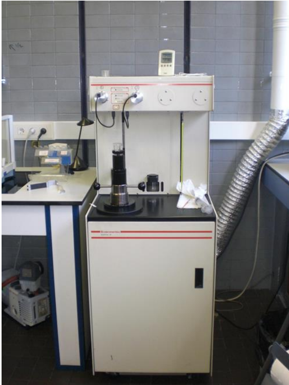
Figura 5.21. Porosímetro de Mercurio Micromeritics AutoPore IV serie 9500, utilizado en este estudio, propiedad del INCAR-CSIC.
