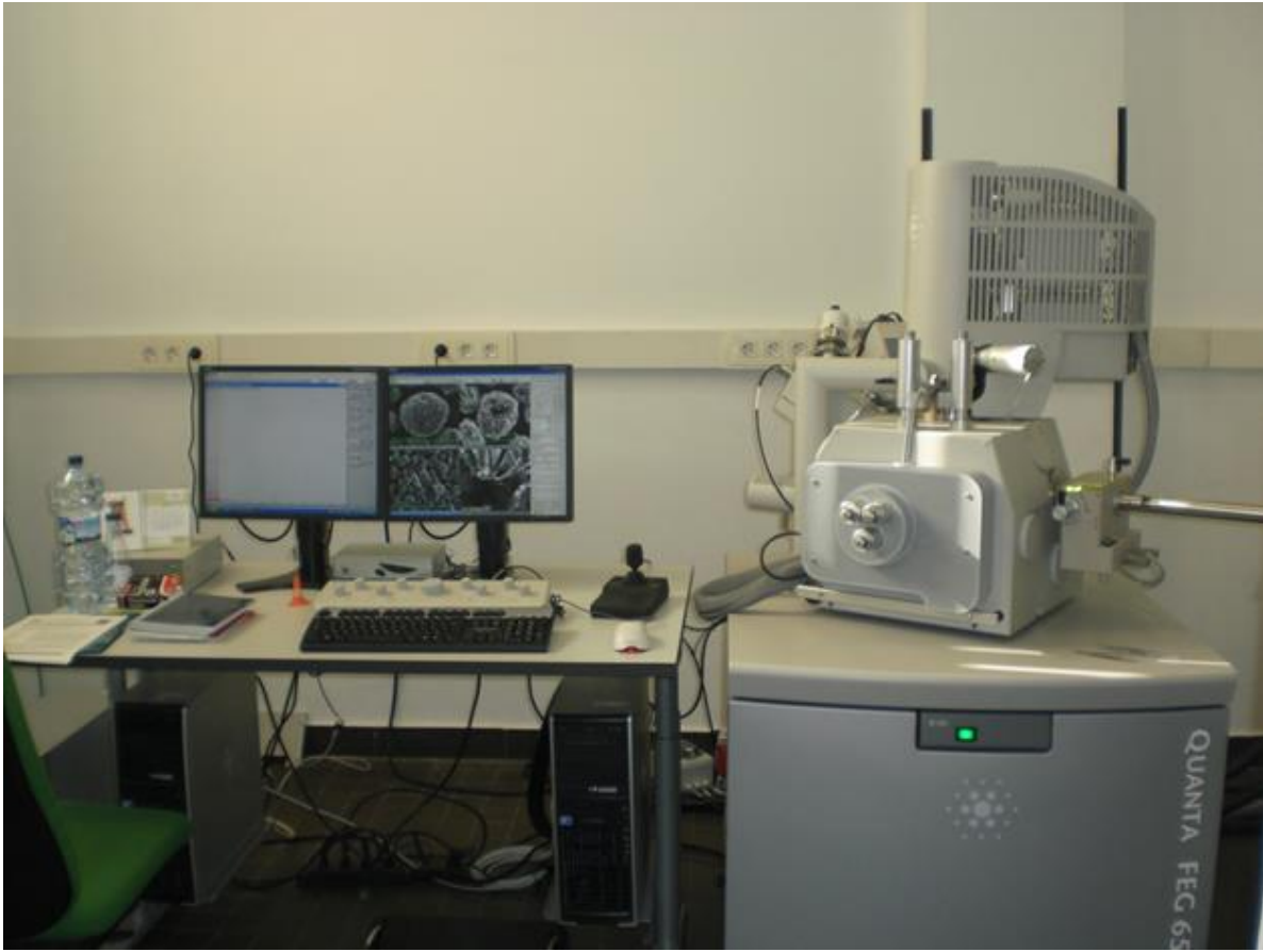
Figura 5.27. Equipo SEM-EDX Quanta FEG 650 que lleva acoplado un EDAX Ametex Genesis Apex 4, utilizado en este estudio, propiedad del INCAR-CSIC.
