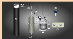
Imagen 2. Diseño experimental. (1) reactor, (2) humidificador, (3) botella de O 2 o N 2 , (4) controlador de flujo, (5) válvula de control, (6) válvula de control de presión, (7) puerto de toma de muestra y (8) controlador PID.
