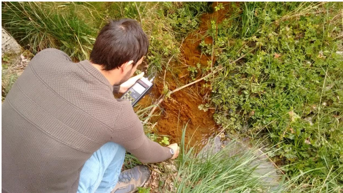
Figura nº28. Medición de temperatura de las aguas de mina del punto de muestreo 6.
