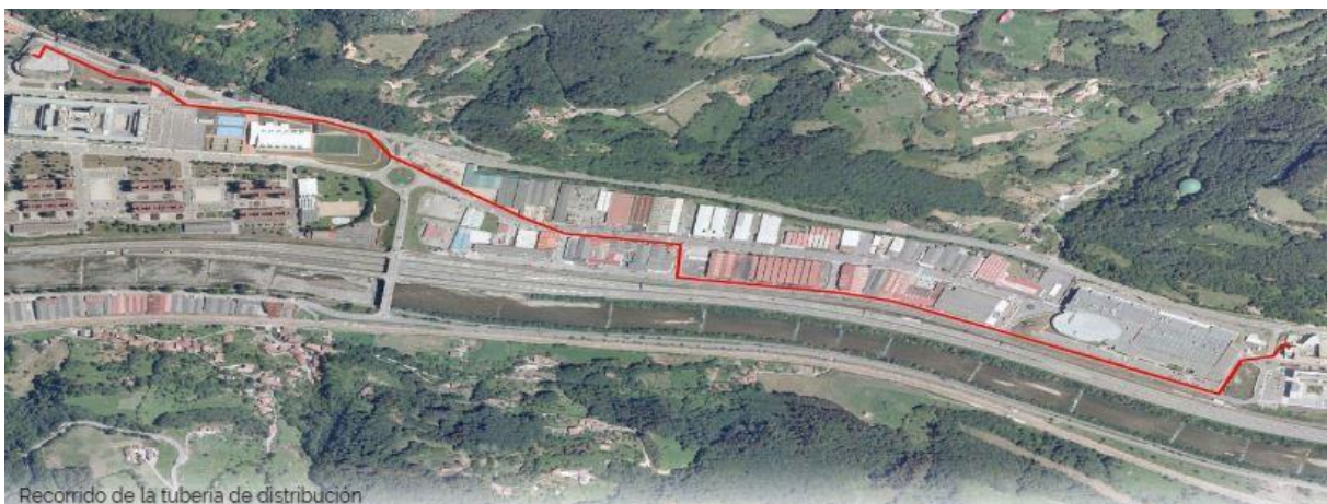
Figura nº12. Recorrido de la tubería de distribución (HUNOSA 2012)
