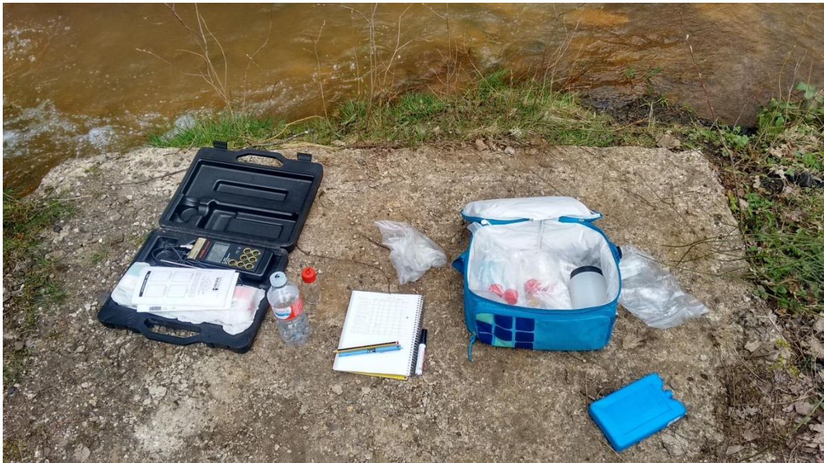
Figura nº29. Material utilizado en la toma de muestras.
