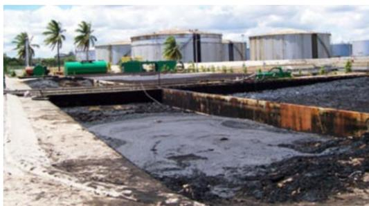
Figura 7. Lodos de fondo de un tanque de almacenamiento de petróleo ([www http://jers-e.com/](http://jers-e.com/))
