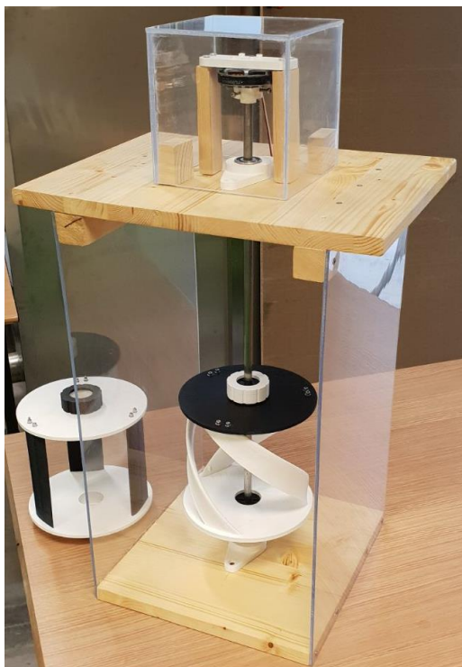
Figura 78. Fotografía de la caja de metacrilato junto con varios rotores que también han sido testeados en el canal. [Fuente: Elaboración propia].
