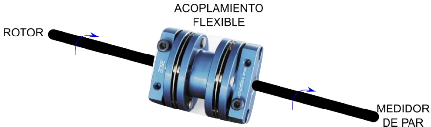
Figura 50. Acoplamiento flexible y su conexión. [Fuente: Elaboración propia].
