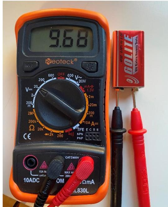
Figura 6.6.- Valor de la pila de 9V medido con un polímetro.
