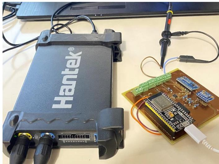
Figura 6.12.- Escenario de medida del generador de señales.
