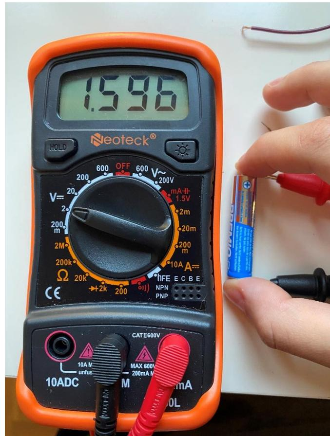
Figura 6.5.- Valor real de la pila medida con un polímetro.
