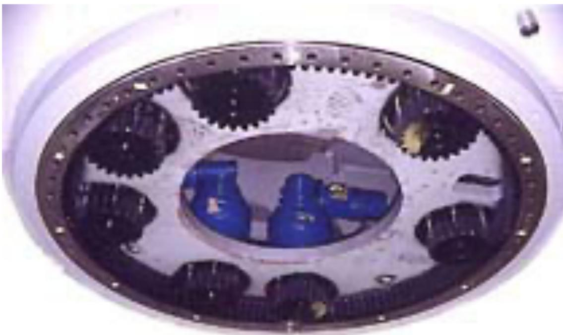
*Ilustración 7. Imagen del mecanismo de orientación de un aerogenerador [23]*
