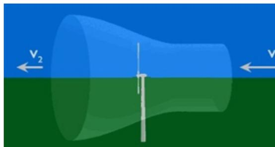
Ilustración 15. Aerogenerador a sotavento [34]
