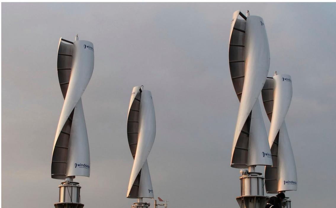
Ilustración 11. Imagen de un aerogenerador Windside o Savonius helicoidal [31]
