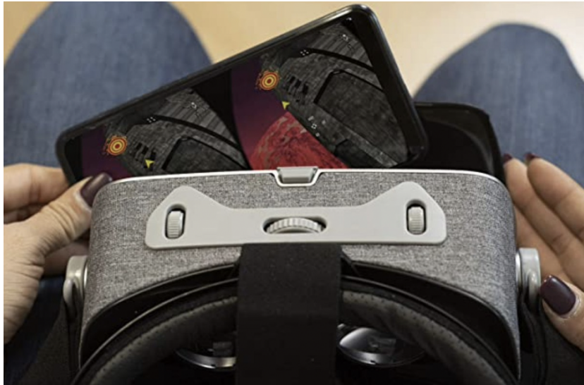
Figura 33: Forma de colocar el teléfono dentro de las gafas de realidad virtual.
