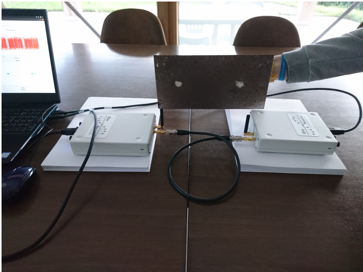
Figura 6.18.- Montaje del sistema para el canal inalámbrico introduciendo un efecto multi-camino.
