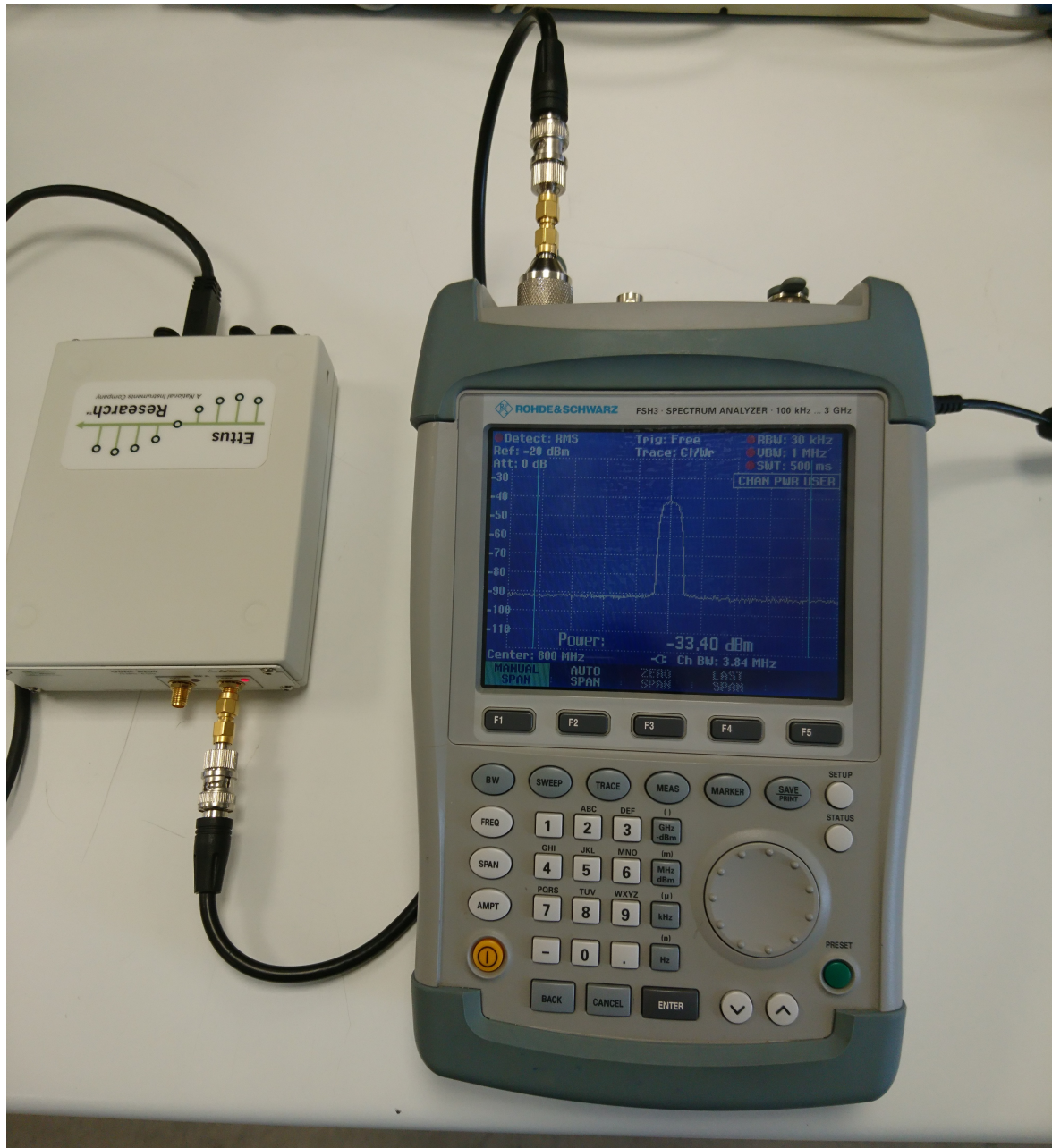
Figura 6.4.- Medida de la densidad espectral de potencia de la señal transmitida por el Tx_Tx utilizando BPSK en la carga útil.
