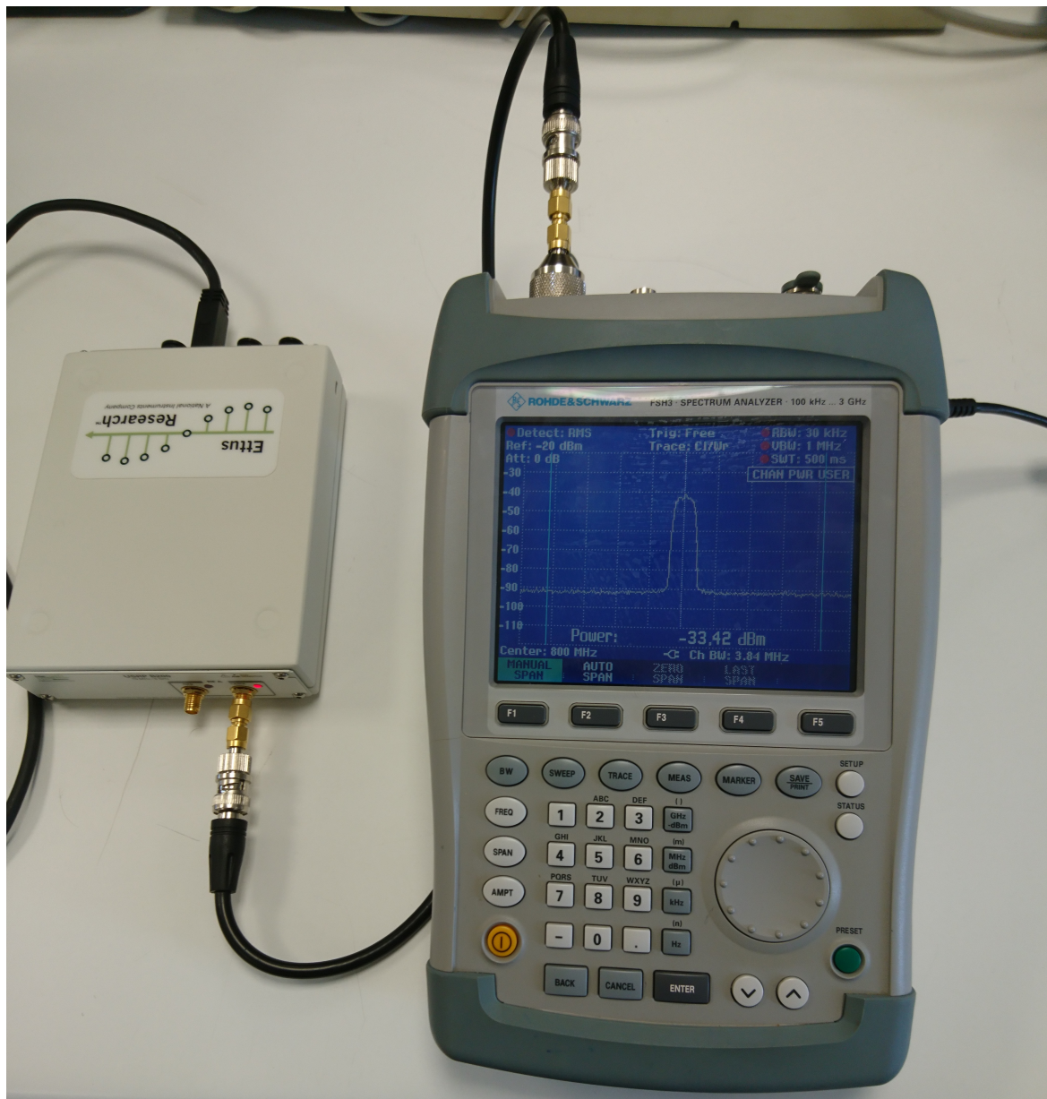
Figura 6.5.- Medida de la densidad espectral de potencia de la señal transmitida por el Tx_Tx utilizando 64-QAM en la carga útil.
