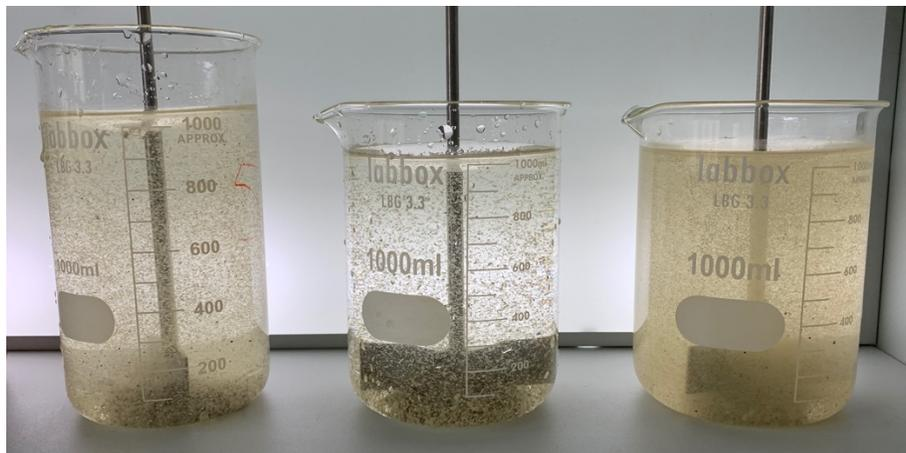
*Ilustración 18. Ensayo laboratorio: JAR-test, momento en el que se añade los floculantes*
