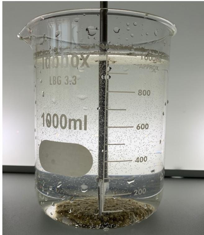
*Ilustración 21. Ensayo laboratorio: Resultado final de la muestra con la adición de coagulante y floculante*
