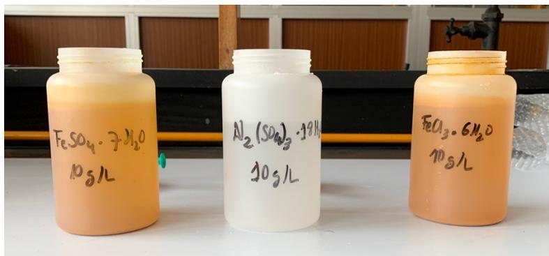
Ilustración 13. Ensayo laboratorio: Coagulantes utilizados en el ensayo. De izquierda a derecha: sulfato de hierro, sulfato de aluminio y cloruro de hierro
