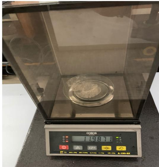
*Ilustración 11. Ensayo laboratorio: pesaje del granito en la báscula.*
