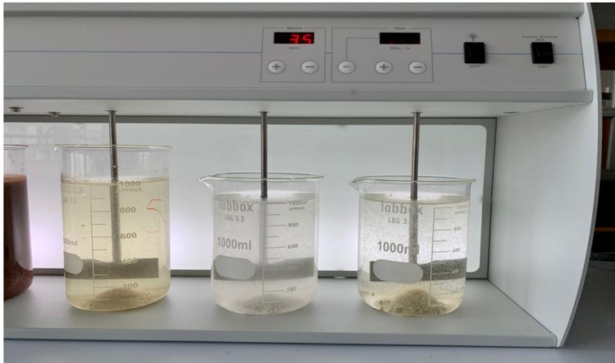
*Ilustración 15. Aspecto de las tres muestras de suspensión de granito tras 5 minutos de mezclado con el coagulante. De izquierda a derecha: sulfato de hierro, sulfato de aluminio y cloruro de hierro*
