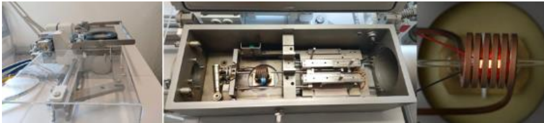
Figura 3. 1. Modulo de la cámara del equipo “Dilatometer Type 805 A/D”, donde se ejecutaron los ensayos correspondientes.
