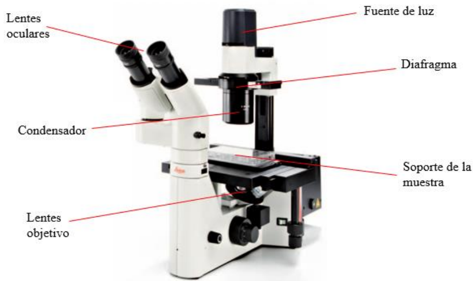
Figura 5. Microscopio óptico LEICA DM IL LED, indicando sus partes más importantes. Imagen modificada del manual del instrumento [30]
