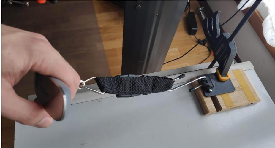
Figura 78. Configuración del ensayo experimental de la fuerza de retención del tope imantado
