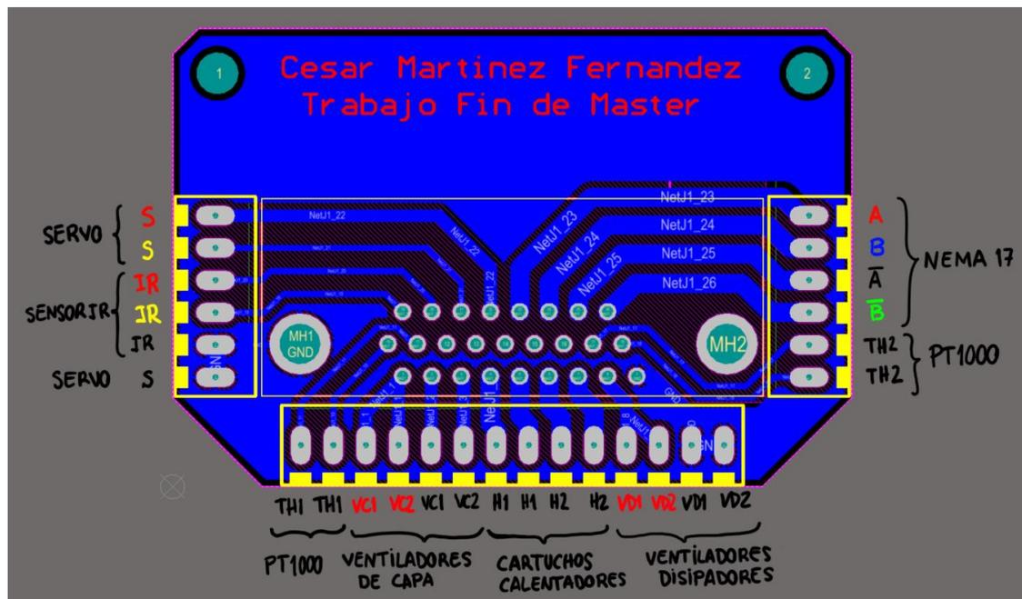
Figura 84. Ruteado de la PCB y detalle de las conexiones de los distintos elementos a sus borneras
