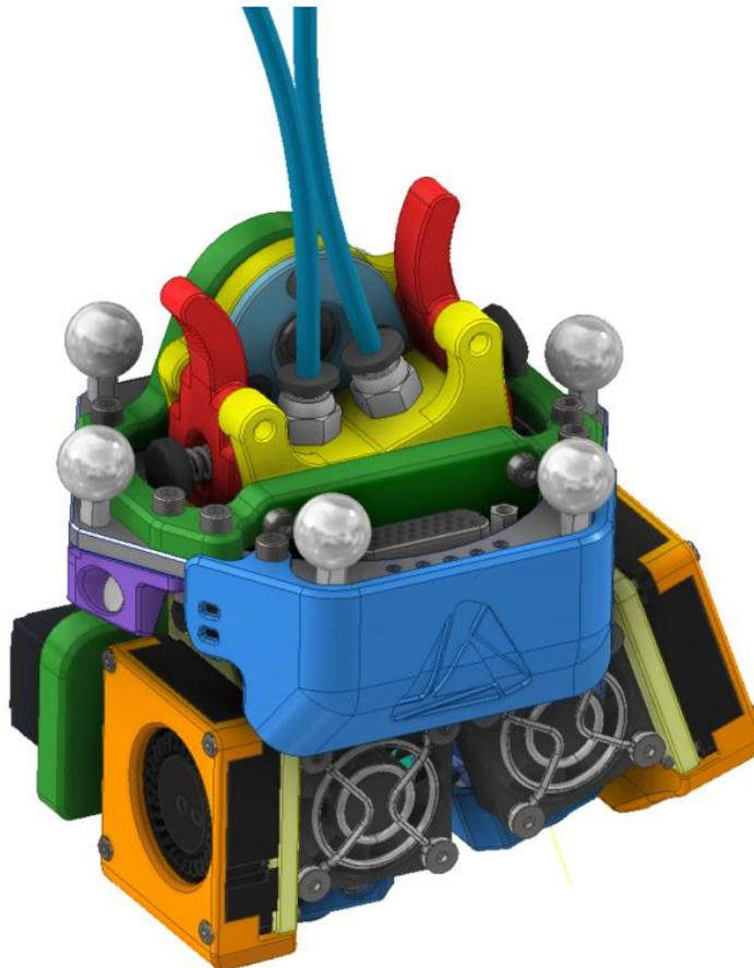
Figura 45. Diseño final del cabezal de doble extrusión
