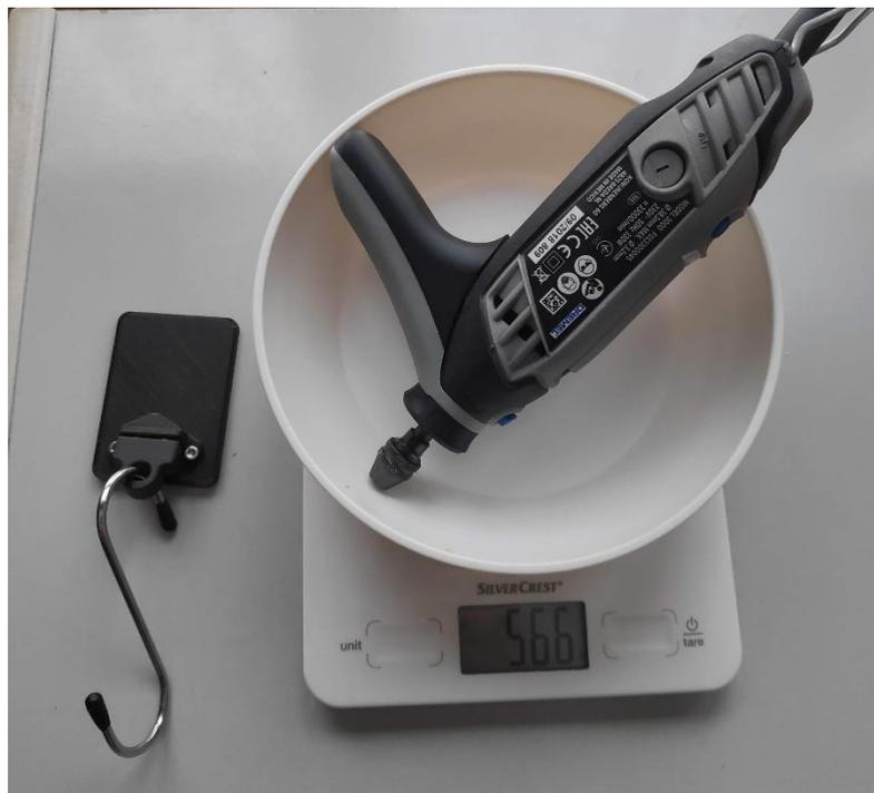
Figura 79. Verificación de la masa soportada usando un Dremel 3000, de masa conocida
